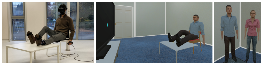
FIGURE 3.1 – Dispositif expérimental avec le casque de RV, les manettes, et les capteurs de suivi disposés sur un participant (gauche), l'environnement virtuel (centre), et les deux avatars proposés (droite). © 2022 IEEE
