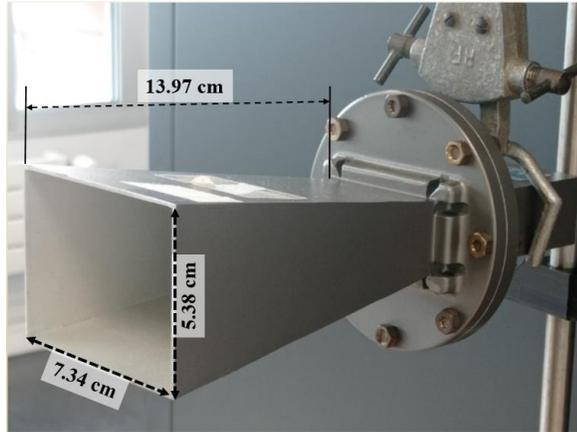
Figure 3.22 Horn antenna ATM® (P/N 187-251-6).
