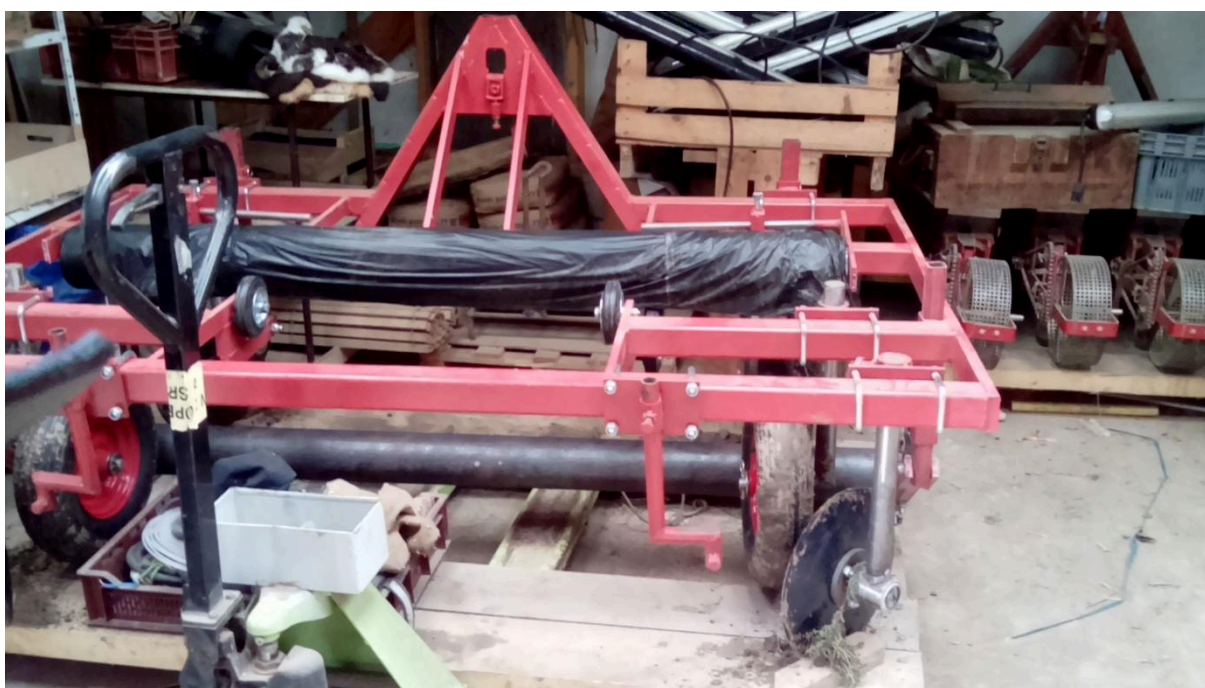
Photographie 4 : Dérouleuse de bâches (G.Bonnel, février 2017)
