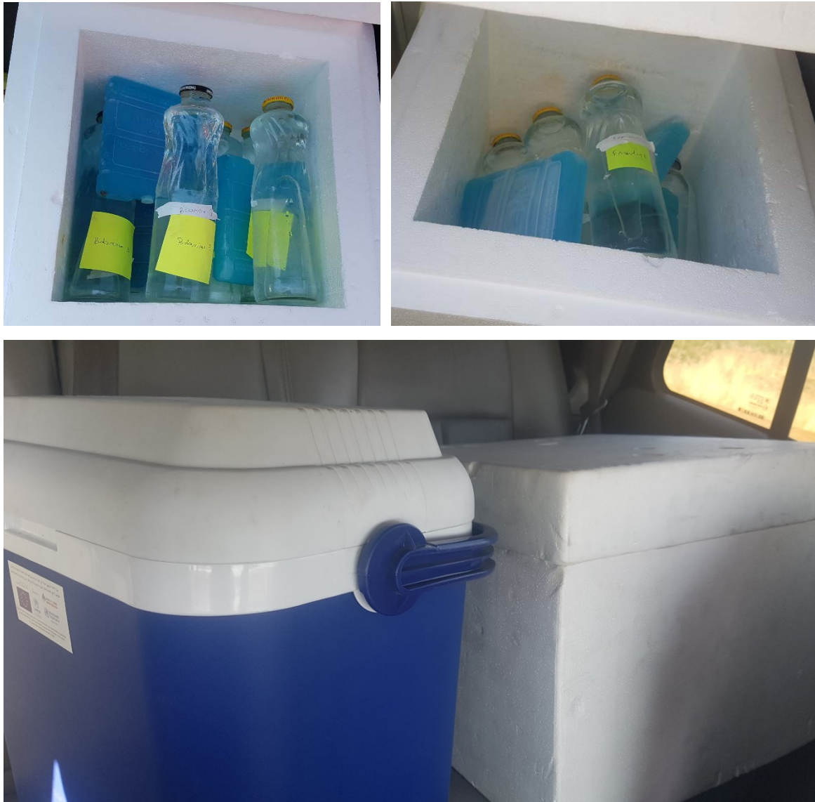
Fig. 76 - La conservation des échantillons dans des enceintes thermostatées réfrigérées
