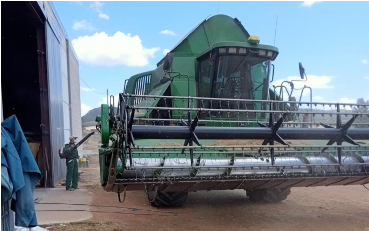
Photographie 23 : soufflage de la moissonneuse. On aperçoit un volume important de poussière accumulée sur la coupe de la machine
