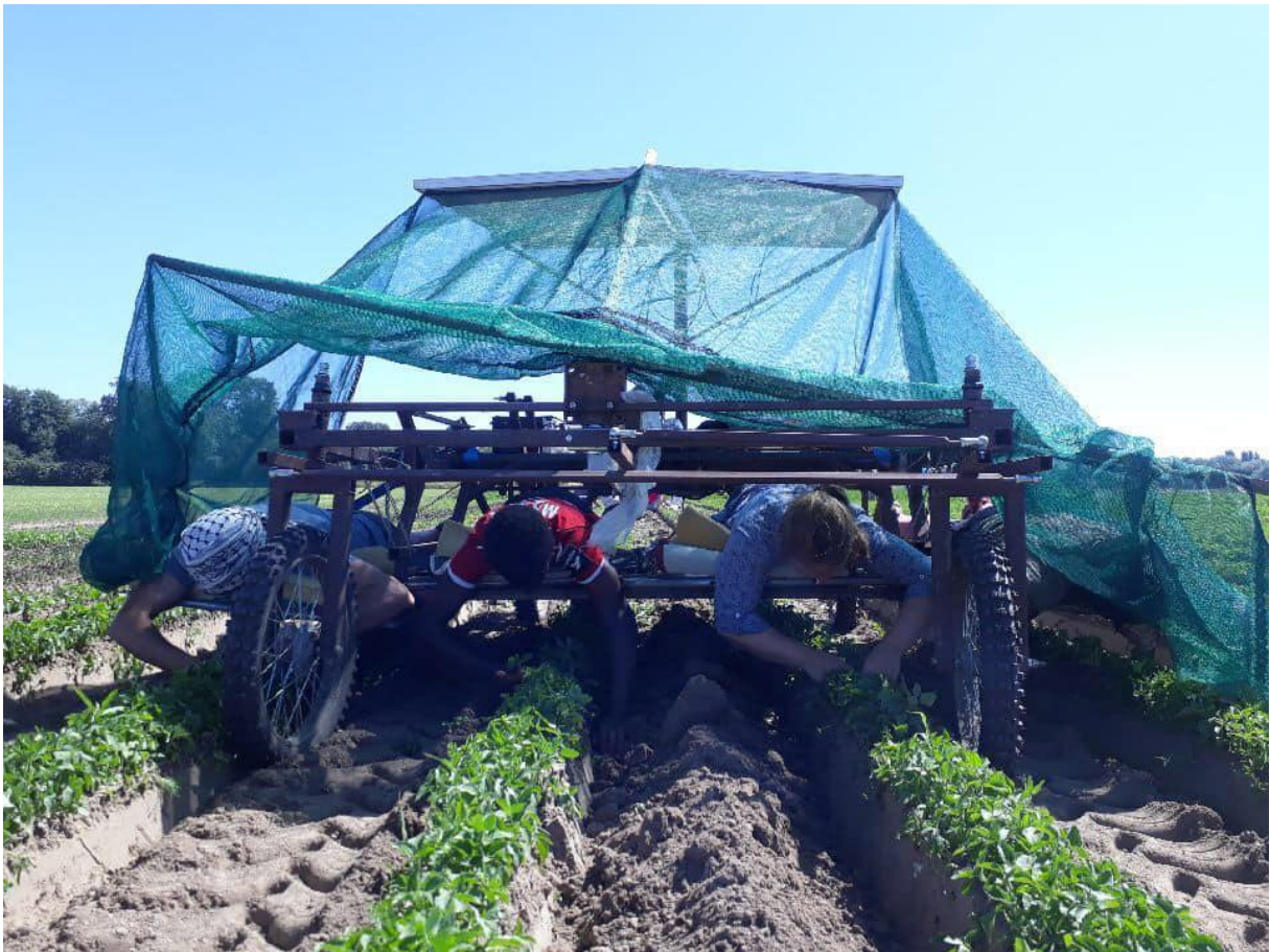
Photographie 30 : lit de désherbage automoteur et alimenté par panneaux photovoltaïques construit par Marjorie sur plans de l'Atelier Paysan et dans le cadre d'un atelier avec cette organisation 404
