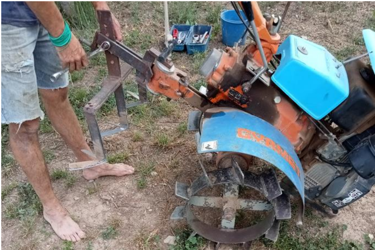
Photographie 12 : le grand motoculteur bleu, un engin à traction hybride, humaine et motorisée
