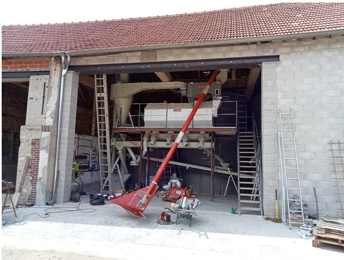
Photographie 29 : le trieur le 22 juillet 2022. Fabrice y a jouté un escalier, des rambardes, des grilles pour faire le tour de l'engin
