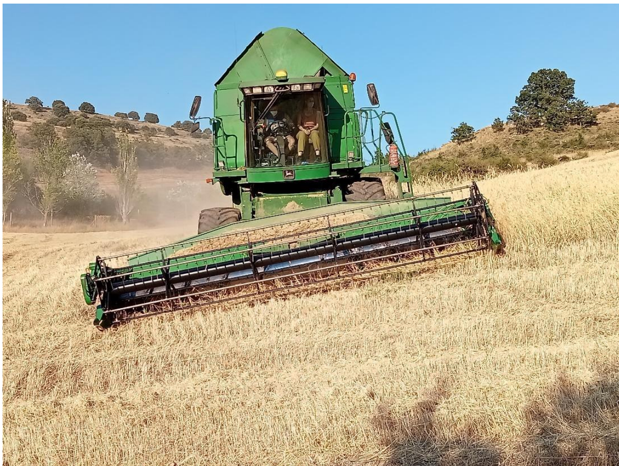
Photographie 19 : la moissonneuse de Kike de modèle John Deere « Hillmaster » capable de travailler en pente
