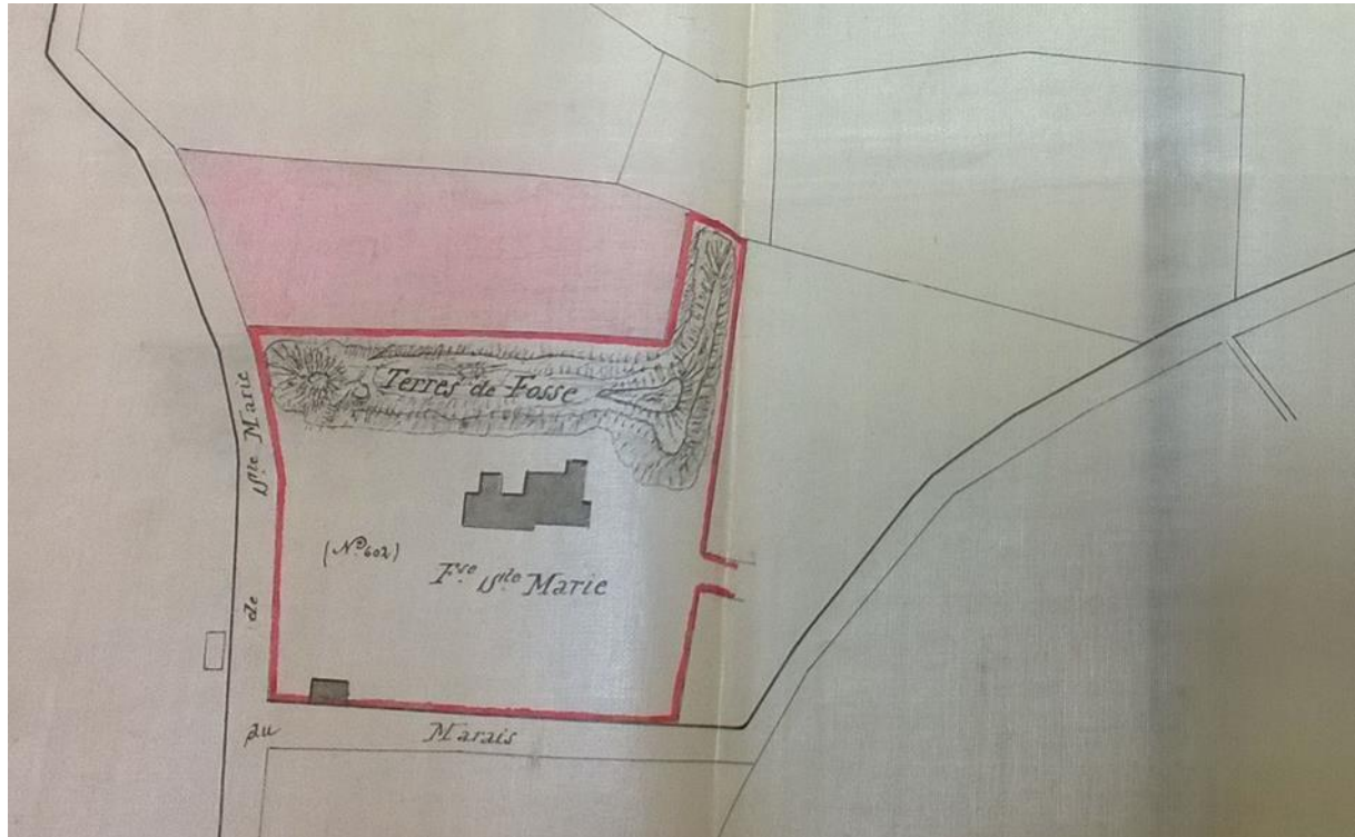
Figure 11 : Plan annexe à la demande de la Compagnie des mines d’Aniche pour occuper un terrain situé près de la fosse Ste-Marie à Auberchicourt, 26 avril 1873. La zone rose est le terrain destiné à accueillir l’extension du terril (Source : ADN, S, 8206).
