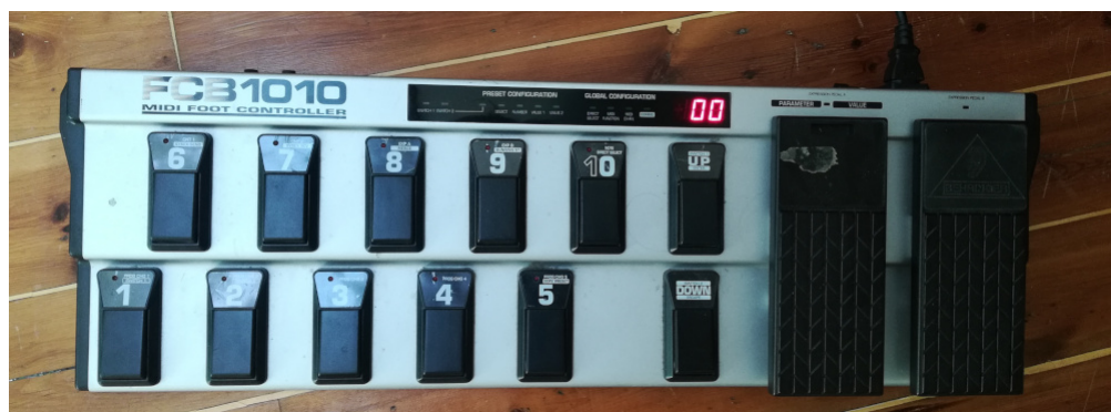
FIGURE 4.8. Pédalier Behringer FCB1010 utilisé dans le scénario 2 pour contrôler l'activation/désactivation des différents traitements.
