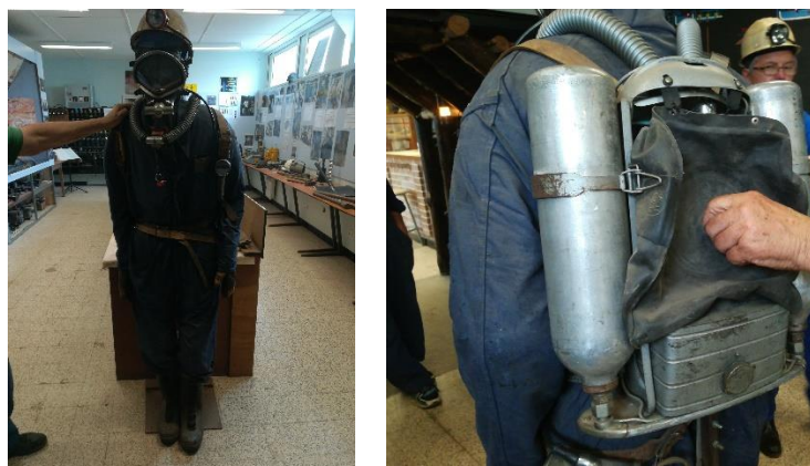
Figure 62 : Appareil de sauvetage Fenzy – Photographies prises par l’auteure à la fosse 2 d’Oignies
