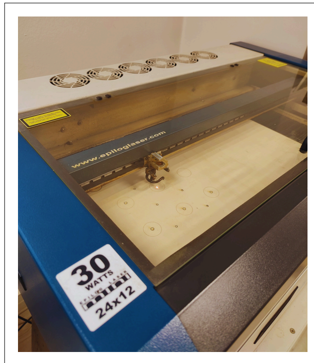
FIGURE 8.5 – Découpe et gravure laser de la plaque supportant les vibreurs.
