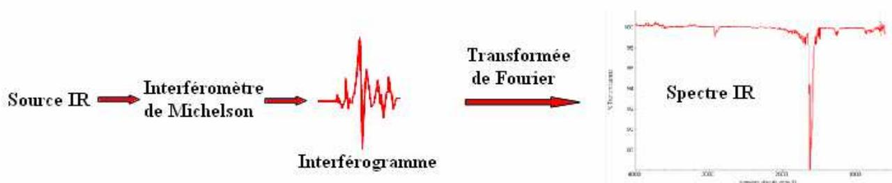
Figure 4.6 : Principe d'un spectromètre d'absorption infrarouge à transformée de Fourier.
