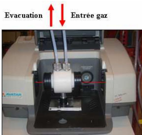
Figure 4.5 : Spectromètre d'absorption infrarouge à transformée de Fourier + cellule en téflon.
