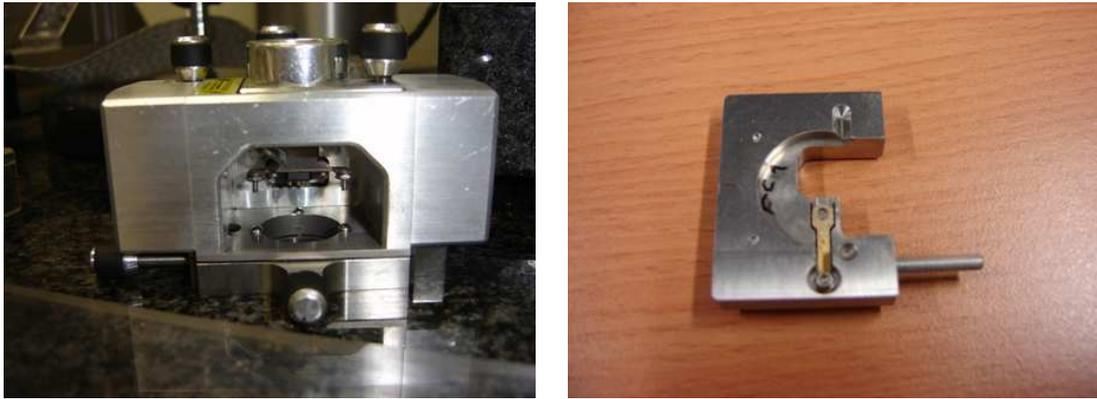
FIG. 1.15 – A gauche : tête du Multimode. A droite : support de pointe.
