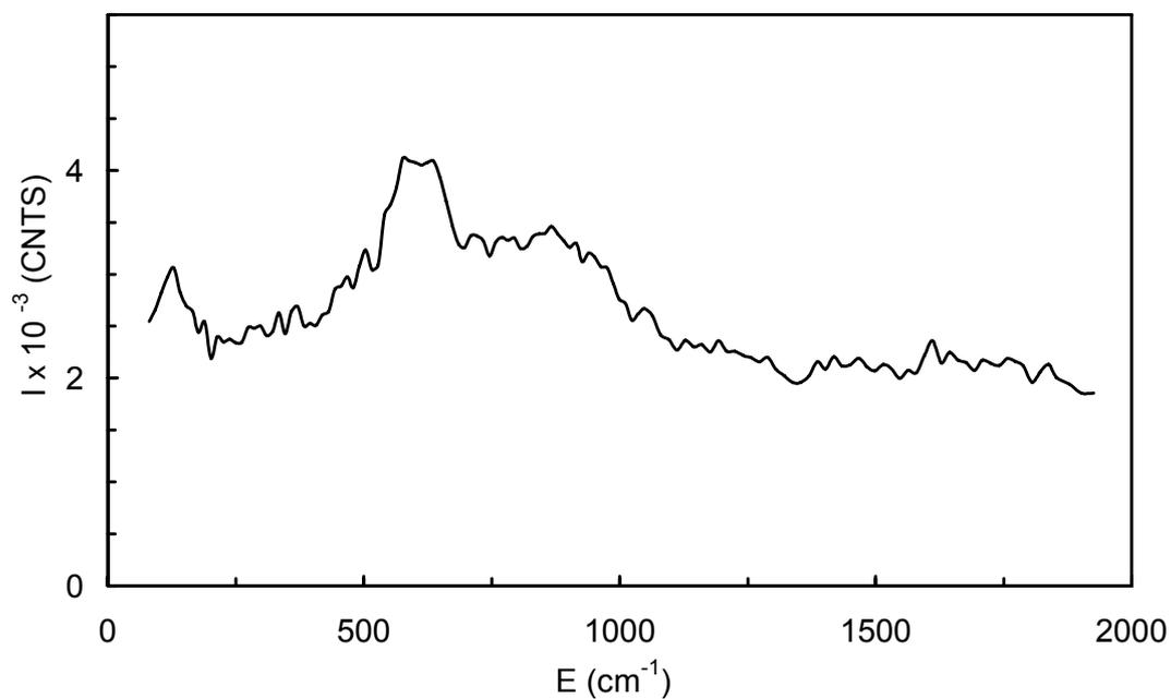
Figure 101 : Spectre INS du  $CeNi_1O_y$  (c) II traité sous flux de  $H_2$  à  $250^\circ C$  pendant 10h, ré-oxydé par air à température ambiante puis pompé pendant 10min dont le spectre du  $CeNi_1O_y$  pompé à  $200^\circ C$  a été soustrait (Figure 94).
