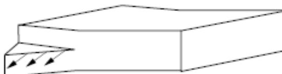
**Figure 91. Schéma représentatif du mode d'ouverture de la fissure (III) dans le cas des films déformés pour observation au MEB.**
