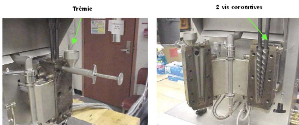
**Figure 21. Photos de la micro-extrudeuse DSM 15.**
