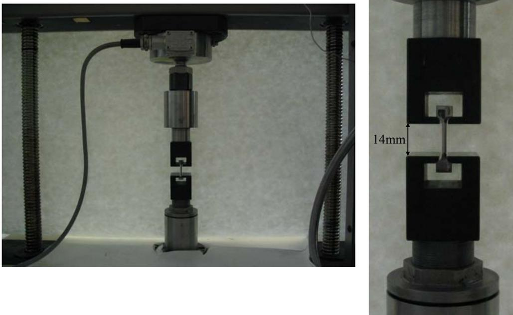
Figure II.8. Ensemble du montage de traction.
