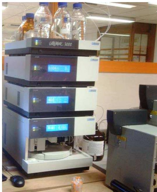
**Figure 3.11** : Image de la chaîne de nano-chromatographie en phase liquide l'Ultimate 3000 de LC-packing (Dionex)
