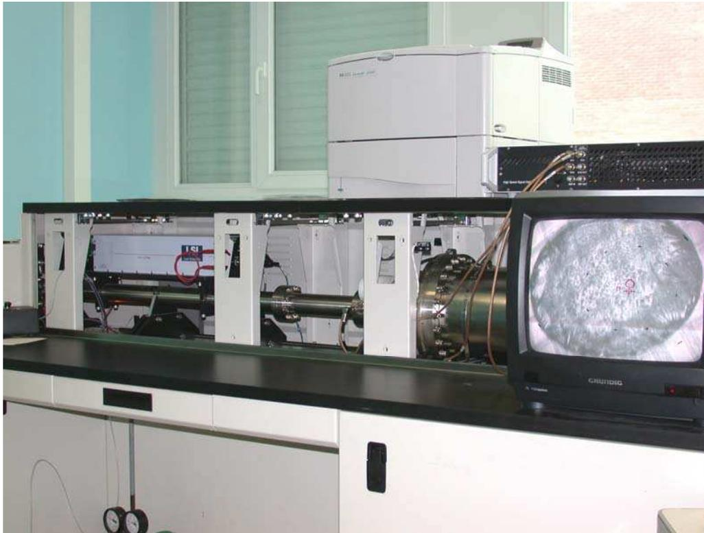
**Figure 2.5** : Image du spectromètre de masse MALDI-TOF (Voyager DE) de chez *Perceptive Biosystems*
