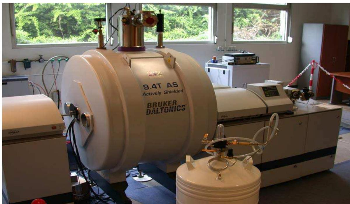
**Figure 3.40** : Spectromètre de masse FT-ICR (APexQE 9,4T, Bruker Daltonics)
