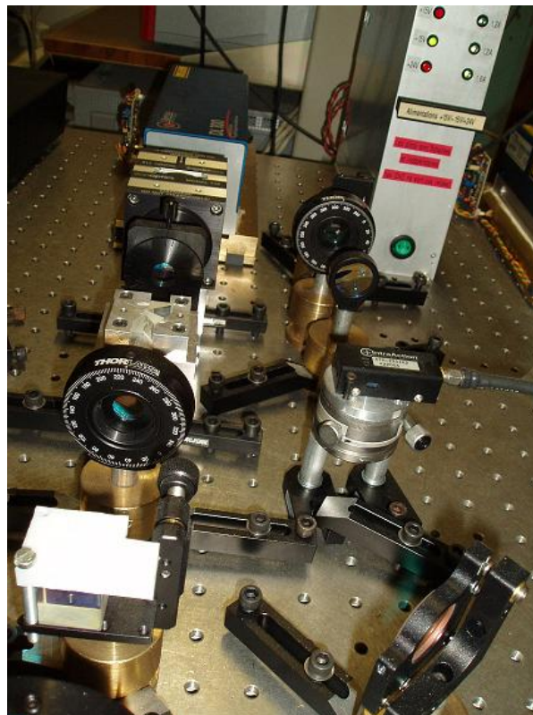
FIG. D.2: Montage modulateur acousto-optique en double passage mis en place pour l'une des diodes.
