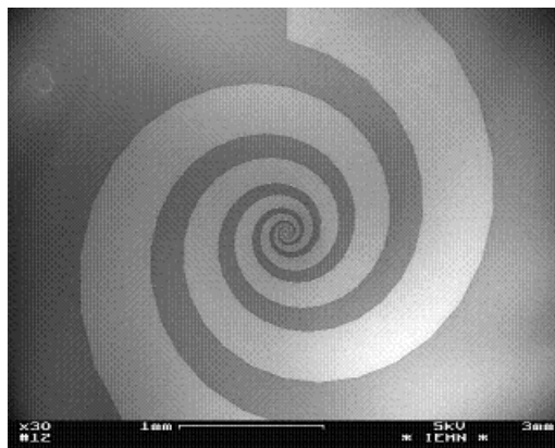
FIG. 2.16: Vue au MEB de l'antenne spirale du photomélangeur permettant l'émission du rayonnement TéraHertz. Le peigne interdigité est inscrit au centre de celle-ci.
