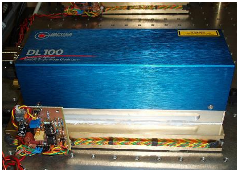
FIG. D.1: Diode laser et son socle d'asservissement en température jouant le rôle de masse thermique.
