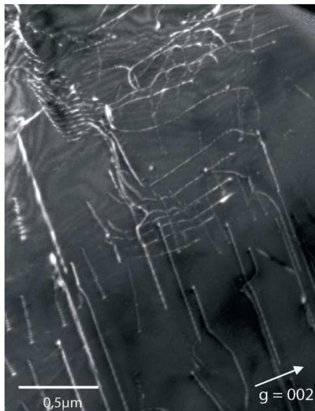
Figure 39 : Image de MET. Champ sombre faisceau faible (WBDF). Sous – joint de grain en formation –  $g = 002$ .
