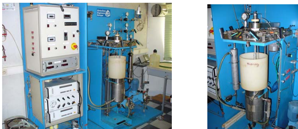
Figure 22 : Dispositif de réduction catalytique du nitrate d'uranyle utilisé par le laboratoire du SEPA de Bessines sur Gartempe (AREVA NC).
