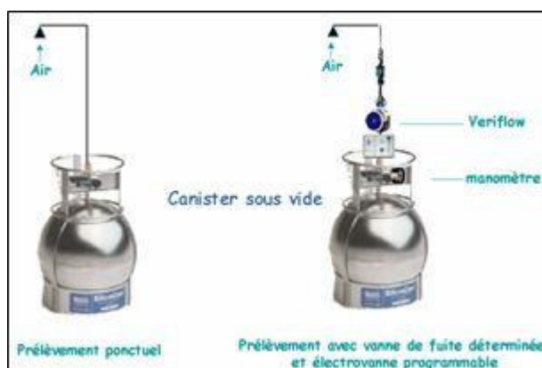
Figure 1-5 : Schéma de principe du canister. (Source : Atmo-franche-comté, site web).
