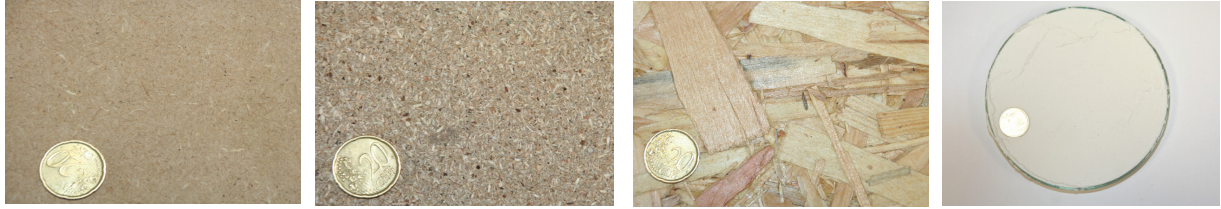
Figure 3-5 : Photos des différents matériaux utilisés pour le choix de la hauteur de prélèvement. De gauche à droite : médium, aggloméré, OSB (Oriented Standard Board) et enduit de rebouchage.
