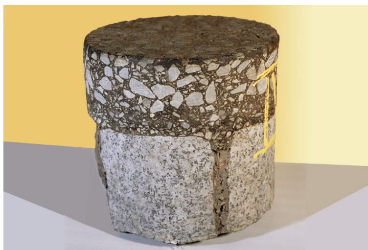
FIGURE 5.7 – Granulat recouvert de bitume, utilisé dans les revêtements de chaussée 174
