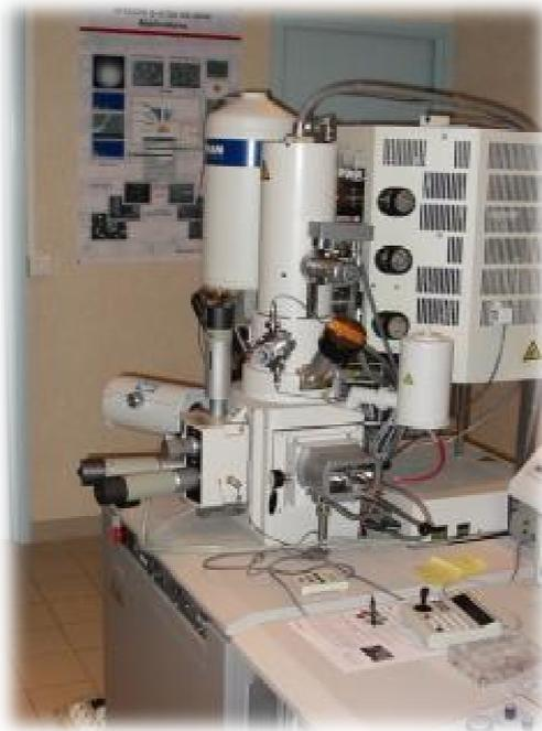
Figure 49. Microscope Electronique à Balayage Hitachi S4700
