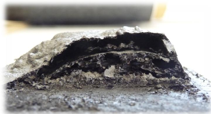
**Figure 109.** « Meringue » formée par un vernis intumescent sur une plaque métallique.
