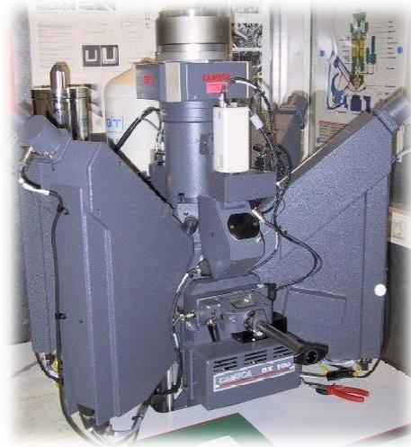
**Figure 47.** Dispositif expérimental de la microsonde électronique de type Cameca SX100
