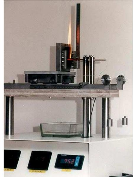
**Figure 39.** Appareillage du fil incandescent
