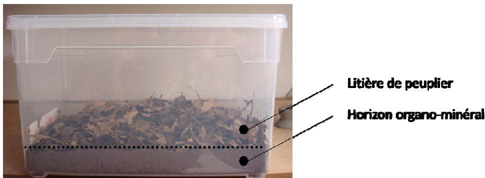
Figure 68 : Structure des microcosmes
