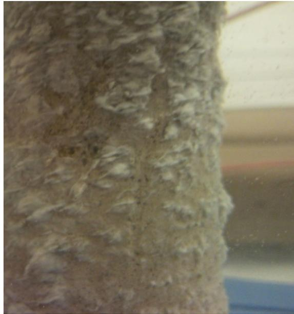
**Figure 58 : Biofilm bactérien de *A. thiooxidans* formé sur la surface du mortier armé CAC**
