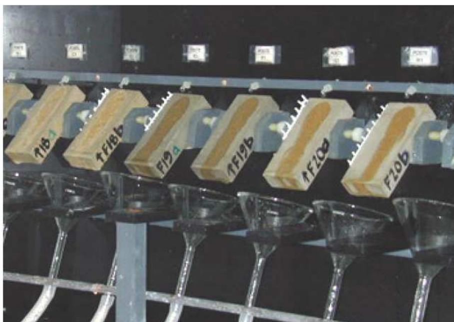
Figure 21 : Dispositif expérimental de lixiviation par  $H_2SO_4$  (Lamberet 2005)
