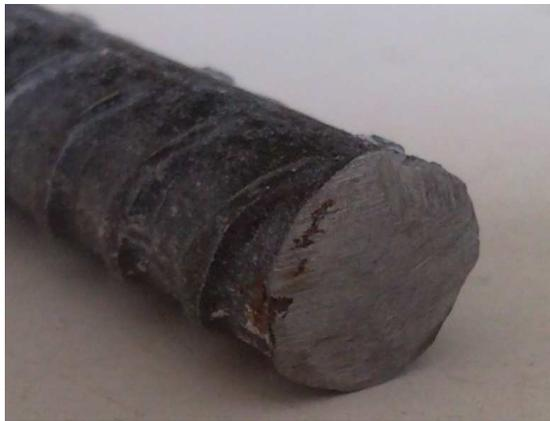
**Figure 126 : Etat de l'armature dans un mortier OPC sain ( $e_1 = 1$  mm) en fin d'analyses électrochimiques**
