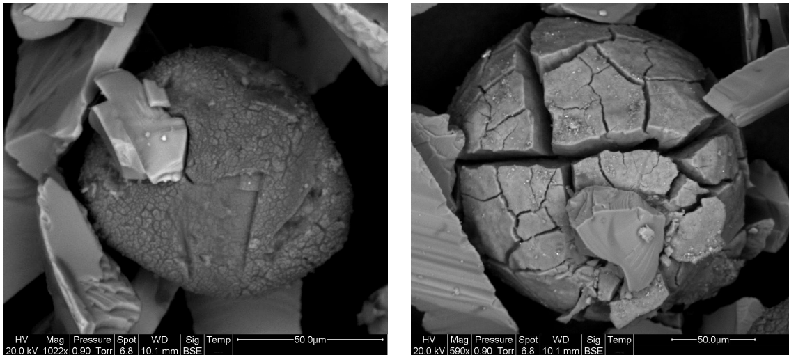
Figures 11 et 12: Grains de catalyseur après test avec simulation d'un emballage thermique à 340°C
