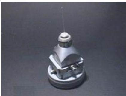
Figure A.2 : Tête goniométrique de diffractomètre sur monocristal.
