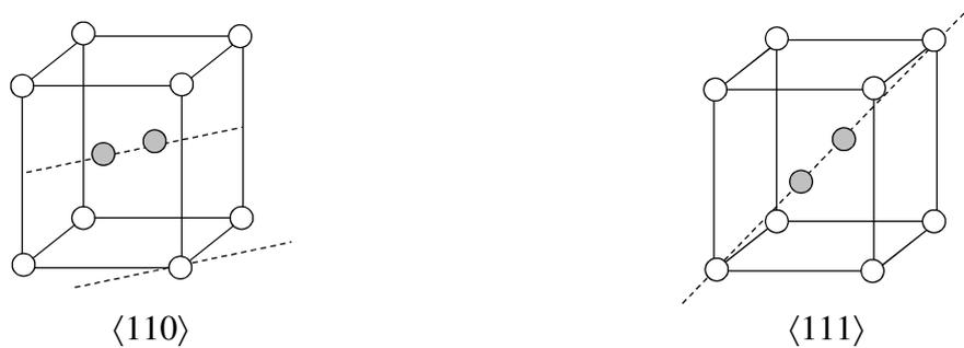
Figure I.1. Schéma des dumbbells de direction  $\langle 110 \rangle$  et  $\langle 111 \rangle$  dans le Fer- $\alpha$ .
