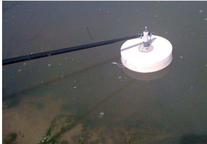
Figure 1-10 : Déploiement de la sonde multiparamétrique en amont du Wimereux. Le support de la sonde est flottant et maintenue par une perche qui est fixé sur berge (photo F. G. Schmitt).
