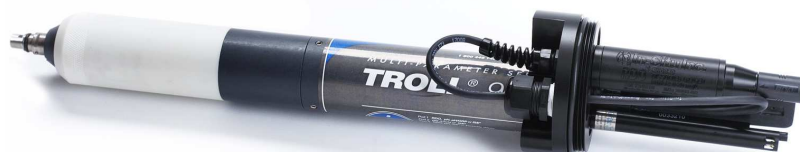
Figure 1-9 : La sonde multiparamétrique : le TROLL 9500. A son extrémité une variété de capteur de couleur noire. Les piles sont insérées dans la partie blanche de la sonde (Source : http://www.in-situ.com ).
