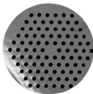
FIGURE 1.19 – Image MEB d'une fibre PCF à grande aire effective (extraite de [85]).
