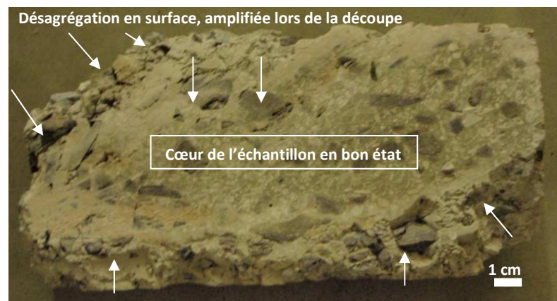
Figure 6.3 Coupe d'un échantillon après 200 cycles de gel/dégel (état G2) – baisse de 50% de UPV
