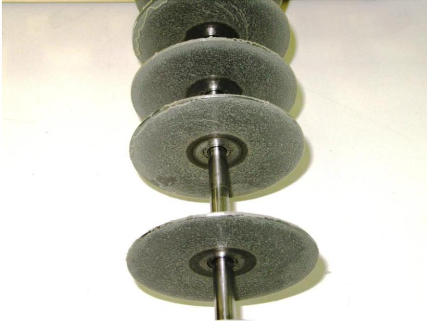
**Figure 51 :** Photographie des disques colonisés par *B. subtilis* ATCC 21332 après 72 h de culture. Les conditions sont : 7 disques sans agitateurs, la vitesse est de  $30 \text{ min}^{-1}$  et l'aération est de  $100 \text{ L h}^{-1}$
