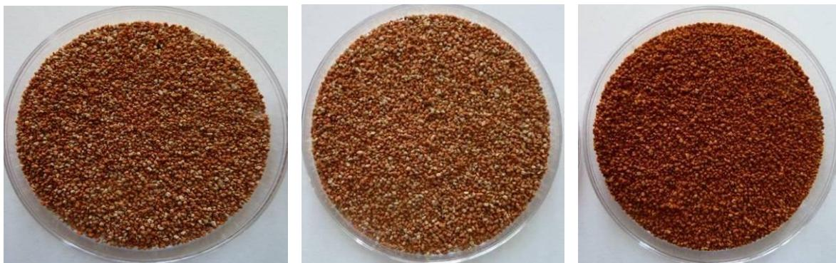
**Fig.11** : Photographie de grains de brique lavés à l'eau, traités 24h avec de l'acide chlorhydrique 1M, et après dépôt de ferrihydrite
