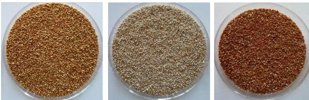
**Fig.14** : Photographies de grains de brique : lavés avec de l'eau, traitée avec l'acide chlorhydrique 6M durant 6h, et après dépôt de ferrihydrite
