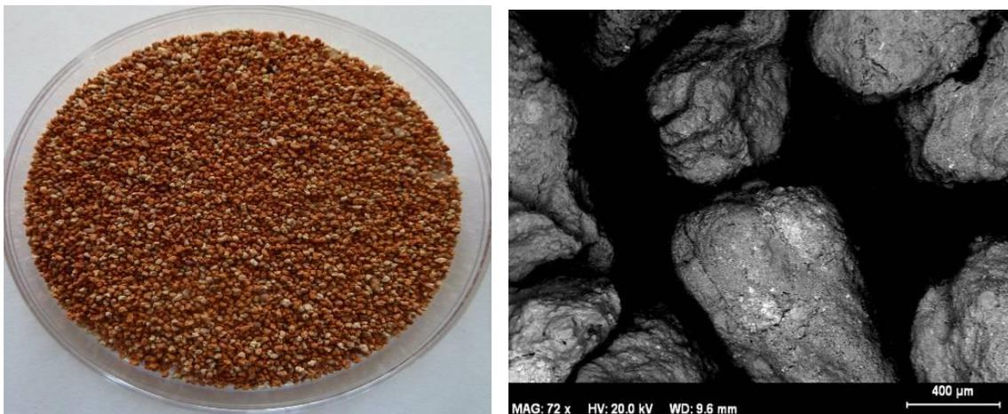
**Fig.9** : Photographie et microphotographie MEB de grains de brique
