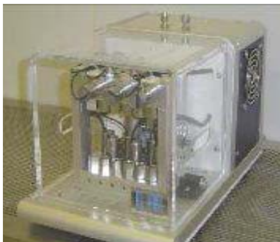
Figure II-12 : le préleveur automatique SyPAC (Système de Prélèvement Automatique Compact)
