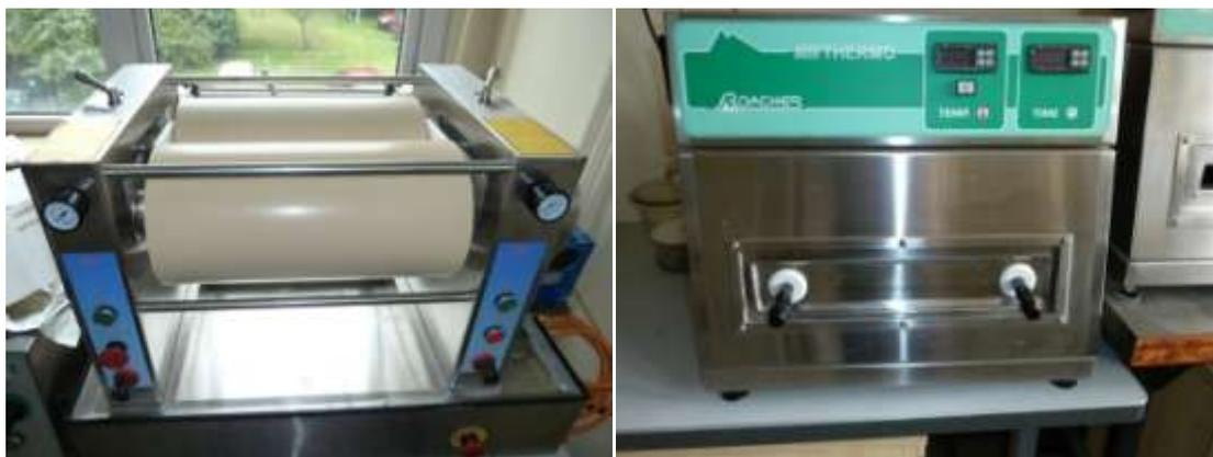
Figure II. 5 : Foulard et rame de finition pour la fonctionnalisation des nontissés (procédé discontinu)
