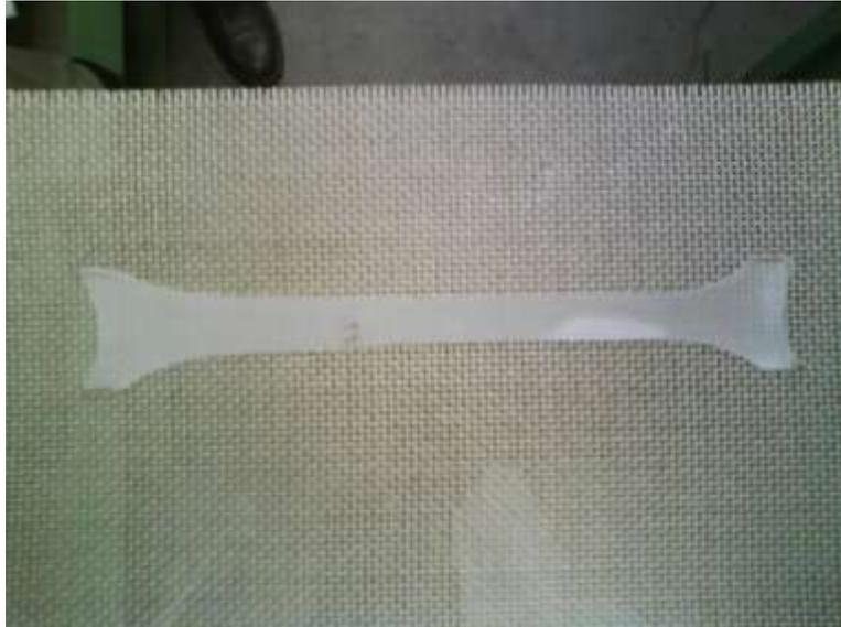
Figure III. 4 : Rétrécissement d'un échantillon polypropylène après traitement thermique à 150°C
