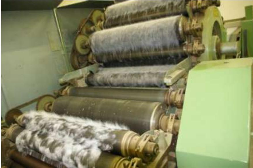
**Figure I. 14 : Procédé de formation de la nappe de nontissé par cardage : ensemble des cardes permettant de démêler, séparer et paralléliser les fibres.**
