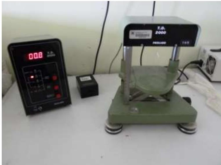
**Figure II. 6 : Tensiomètre Prolabo T.D. 2000**
