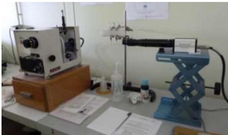
Figure II. 9 : Installation de mesure de l'angle de contact : "Face contact-angle meter " + caméra
