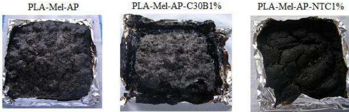
Figure 78 : Résidus des formulations PLA-Mel-AP, PLA-Mel-AP-C30B1% et PLA-Mel-AP-NTC1%
