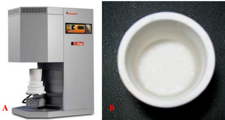
*Figure 2:* A) Four utilisé au laboratoire, B) Creuset en alumine après cuisson.
