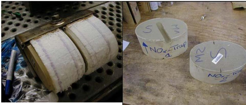
*Figure 13 : photos du catalyseur NO<sub>x</sub>Trap Bluetec contenant 2 monolithes*
