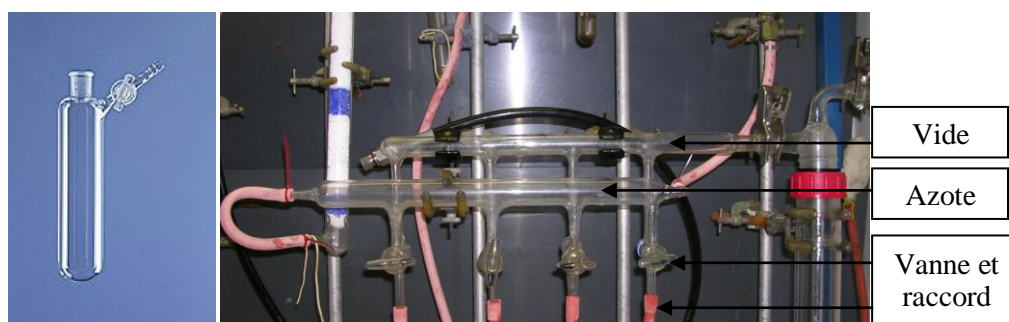
Figure 2–17. Photo d'un tube de Schlenk et système de rampe vide/azote
