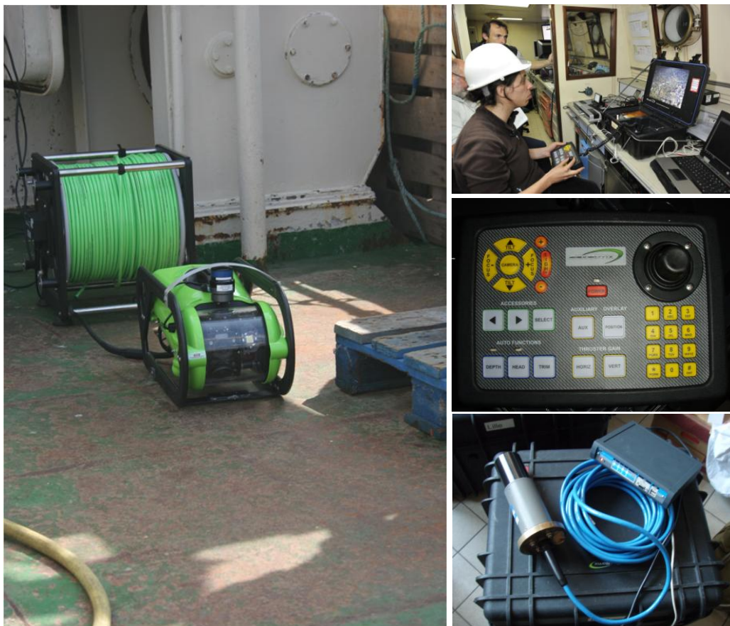
Figure IV.10 : Equipement vidéo avec le ROV (sans les lampes externes) et son ombilic à gauche, et à droite de haut en bas, l'installation dans le laboratoire à bord du « Côtes de la Manche » (crédit photo Olivier Dugornay), le boîtier de commande et le système de positionnement (Tritech Micronav100) (Crédit photos : Sophie Lozach).
