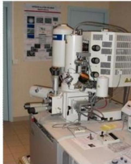
***Figure I.5 – Microscope Electronique à balayage HITACHI S4700***
