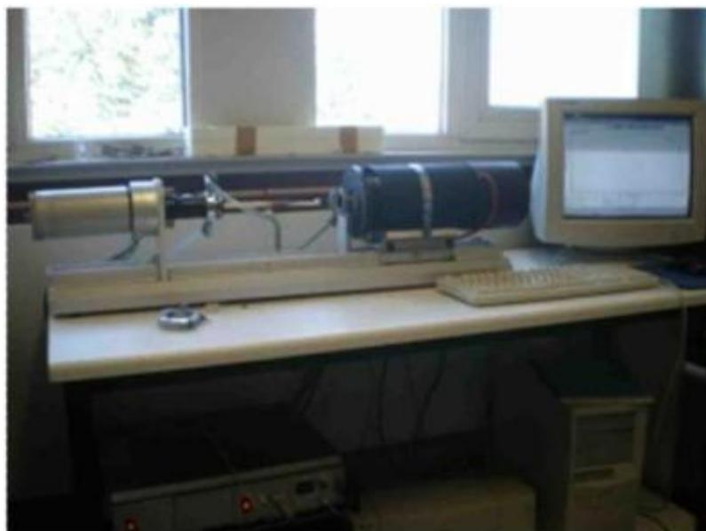
**Figure I.10** – Dilatomètre Linseis, L75 standard horizontal, porte-échantillon alumine unique, 20-1600°C.
