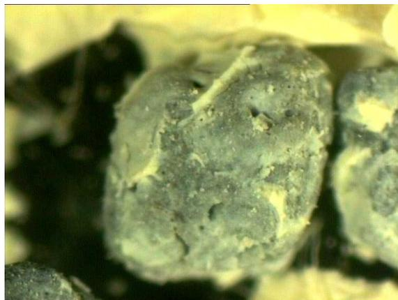
Figure 51: Photo d'un grain de  $\text{U}_3\text{O}_8$  d'environ 1mm de diamètre entouré d'une couche de  $\text{UO}_4 \cdot 4\text{H}_2\text{O}$
