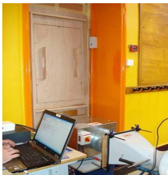
Figure 23 : Ventilateur, fausse porte, micro-manomètre et système d'acquisition des données à l'extérieur (à gauche) et à l'intérieur de la classe (à droite) de l'école d'Arras lors de la campagne 2009.
