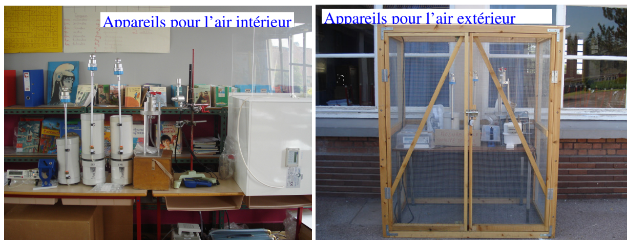
Figure 41 : L'ensemble des matériels utilisés pour la mesure et le prélèvement à l'intérieur et l'extérieur de l'école de St Pol sur Mer (03-17/06/2009).
