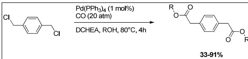
**Schéma I-37 : double alcoxycarbonylation de bis(chlorométhyle)benzène**
