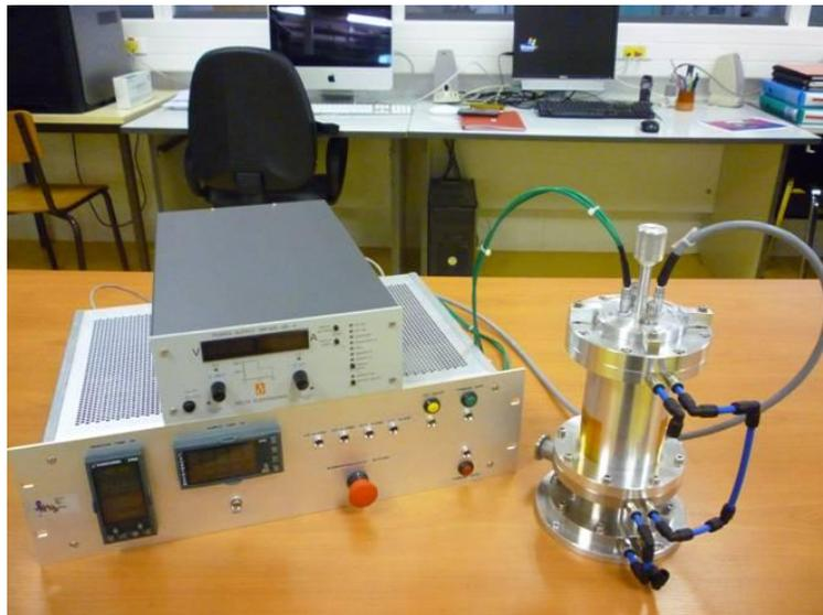
Figure 95: Cellule operando XAS-Raman développée à SOLEIL
