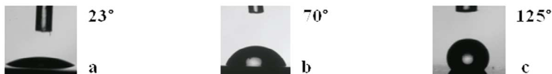
Figure V.23 : Evolution de l'angle de contact (eau) d'une surface de titane oxydée (a), fonctionnalisée par l'ancre Dopamine-N 3 (b) et après la réaction de chimie « click » avec le dérivé du Zonyl (c)
