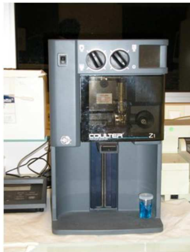
Figure VIII.11 : Compteur de Cellules (ZI Coulter)
