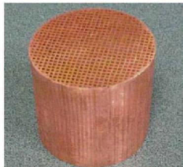
Figure 5. Exemple de monolithe en cuivre [35].
