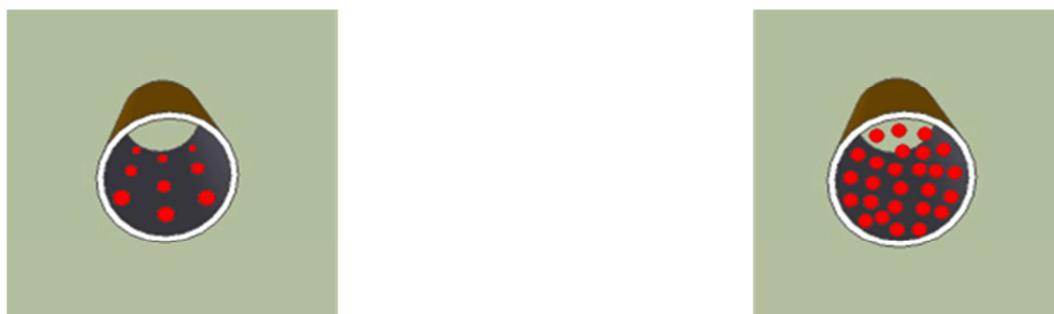
**Fig.1** Représentation schématique des deux voies adoptées pour immobiliser les particules d'or au sein des microcapillaires ; Gauche : 2D ou Open tubular et droite : 3D ou Monolithe (les sphères rouges représentent les nanoparticules d'or).
