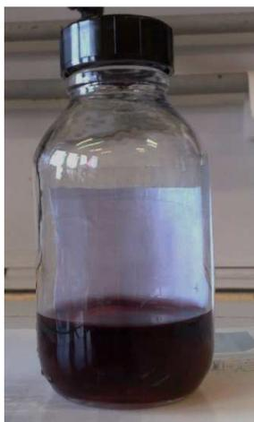
*Fig.1 Solution colloïdale d'or synthétisée en utilisant le protocole de Turkevich.*
