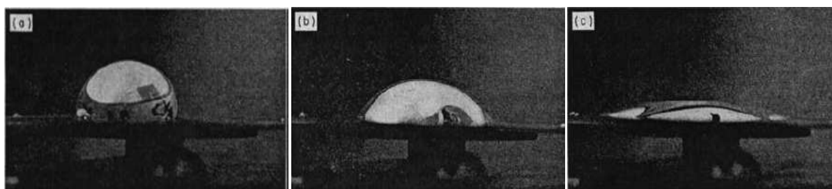
Figure I.24: Une goutte de sodium sur un substrat de nickel : a) contaminé, \theta_c=115 °, b) partiellement décontaminé par bombardement ionique, \theta_c=55 °, c) quasi-entièrement décontaminé, \theta_c=20 ° [BAR-1969].
