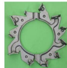
Figure 1 – Procédé de mise en forme des ventilateurs de refroidissement de l'alternateur à partir d'une tôle mince : a) étapes de fabrication, b) détails des étapes de fabrication, c) géométrie finale.
