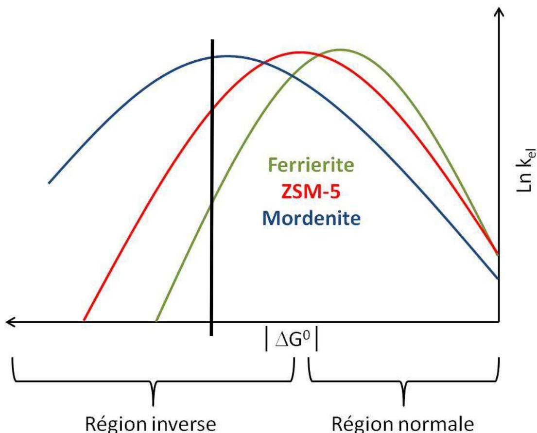
Figure 28 : Variation de  $\ln k_{el}$  (avec  $k_{el}$  la constante de vitesse de transfert des électrons) en fonction de la valeur absolue de l'enthalpie libre standard  $|\Delta G^0|$  pour  $\lambda$  constant.
