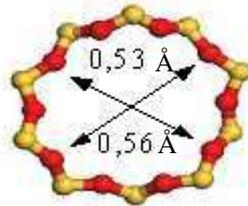
Figure 2 : Cycle à 10 tétraèdres selon l'axe [010] (canal droit).
