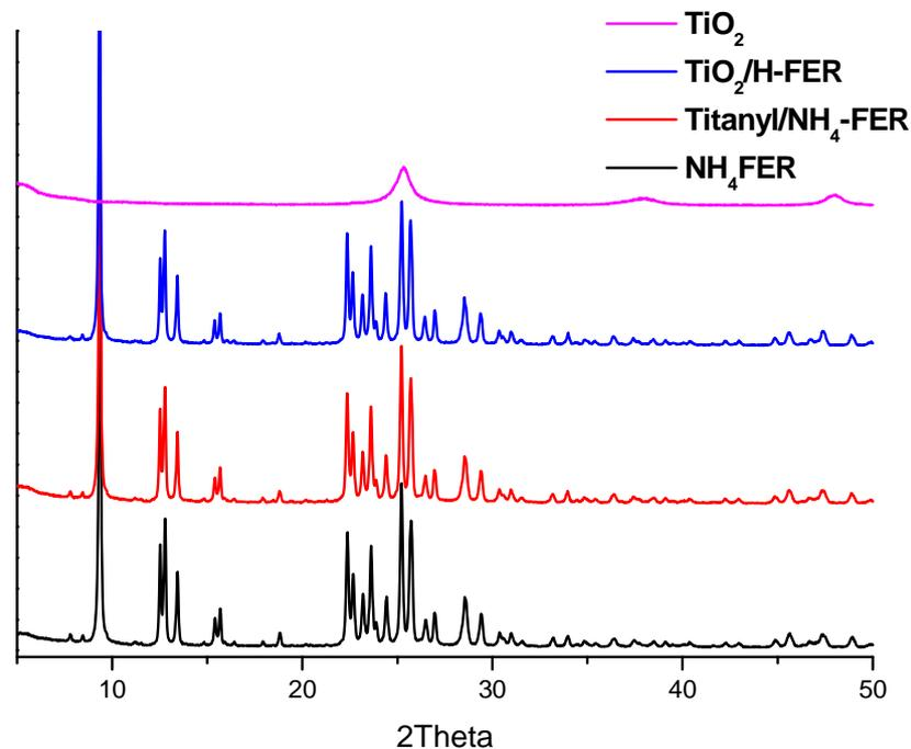
**Figure 6 :** Diffractogrammes obtenus pour  $\text{NH}_4\text{-FER}$ , Titanyl/ $\text{NH}_4\text{-FER}$ ,  $\text{TiO}_2/\text{H-FER}$  et  $\text{TiO}_2$  anatase.
