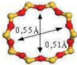
Figure 3 : Cycle à 10 tétraèdres selon l'axe [100] (canal sinusoïdal).
