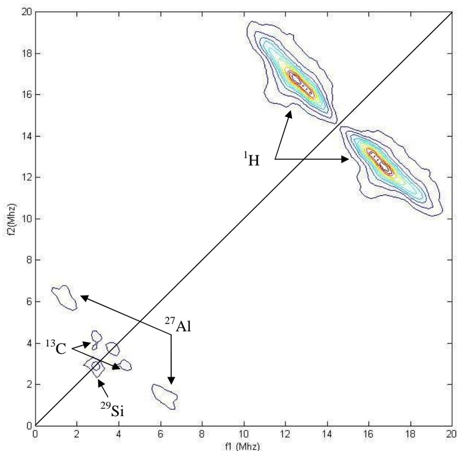
**Figure 11** Spectre expérimental 2D-HYSCORE enregistré à température ambiante (25°C) de *t*-St@TiO<sub>2</sub>(TiCl<sub>3</sub>)/H-ZSM-5<sup>•+•-</sup> (Si/Al=13,5), 2 mois après le mélange des poudres.
