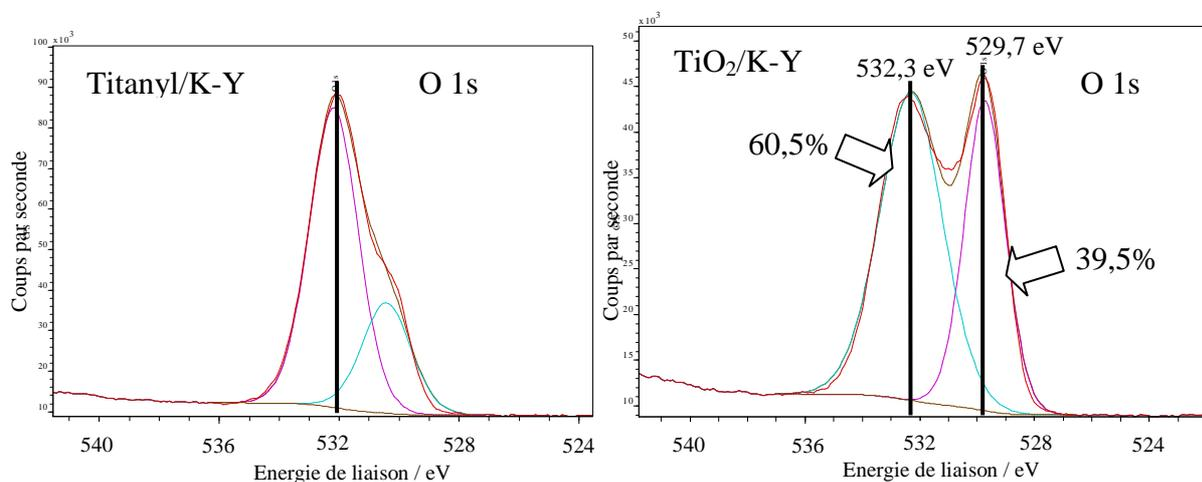
Figure 30 : Spectre XPS de l'O 1s de titanyl/K-Y et TiO<sub>2</sub>/K-Y.
