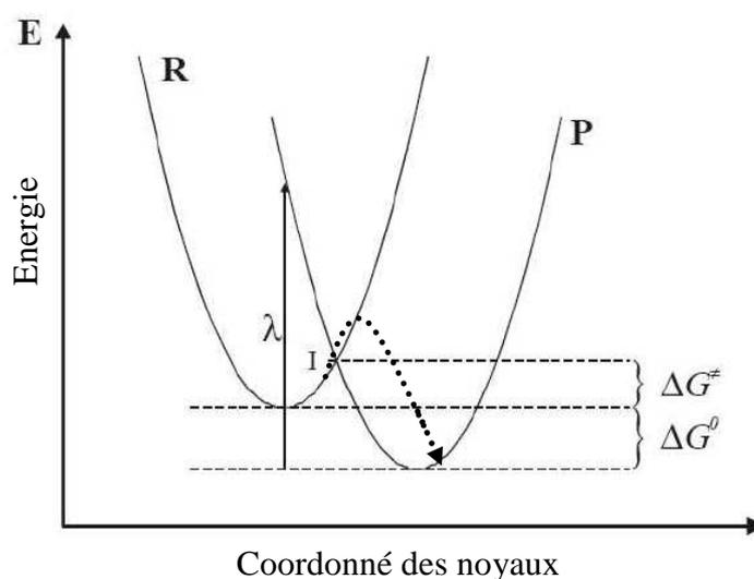
**Figure 37 : Représentation de la non-adiabaticité d'une réaction de transfert d'électron à l'aide de surfaces de potentiels d'un réactif R et d'un produit P.**
