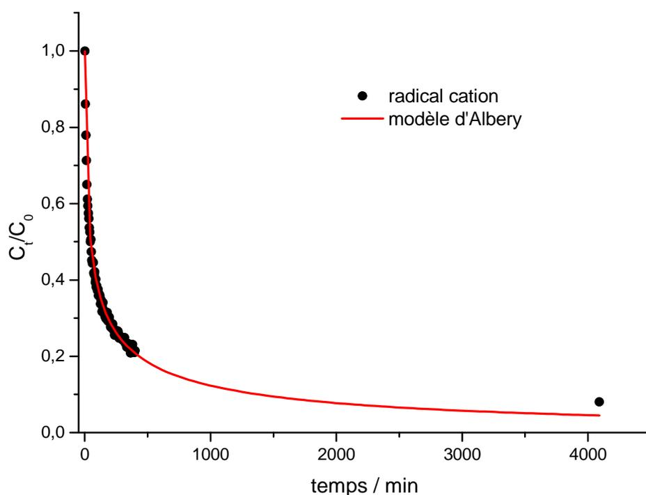
**Figure 35 :** Décroissance de la concentration spectrale en  $t\text{-St}^{\bullet+}@ZnS_{(S2)}/Na\text{-ZSM-5}^{\bullet}$  (Si/Al=13,5) en fonction du temps après photoexcitation à 300 nm de l'échantillon  $t\text{-St}@ZnS_{(S2)}/Na\text{-ZSM-5}$  (Si/Al=13,5).
