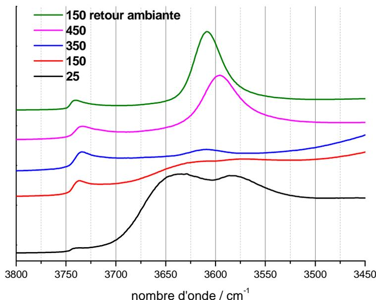
Figure 10 : Evolution des spectres DRIFT observée en fonction de la température lors du chauffage de titanyl/(NH<sub>4</sub>)-ZSM-5 (Si/Al=13,5).
