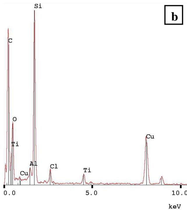
Figure 26 : (a) microphotographie MET de TiO<sub>2</sub>/H-MOR, (b) spectre EDX de la zone délimitée par le cercle vert.
