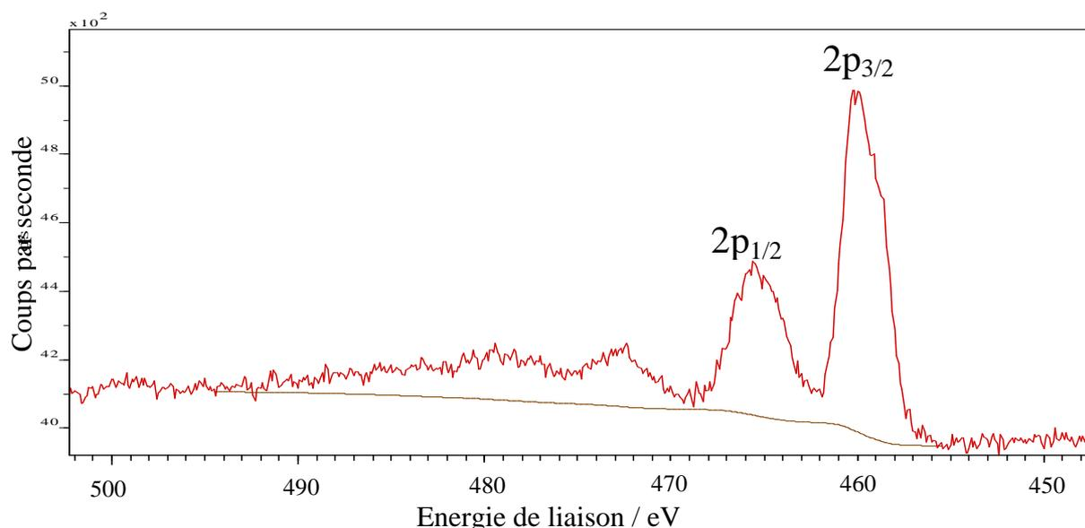
Figure 22 : Spectre XPS de Ti 2p pour TiO<sub>2</sub>/H-MOR.
