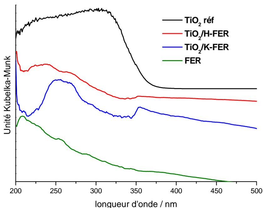
Figure 7 : Spectres UV-visible en réflexion diffuse de la FER,  $\text{TiO}_2/\text{K-FER}$ ,  $\text{TiO}_2/\text{H-FER}$  et  $\text{TiO}_2$  anatase.
