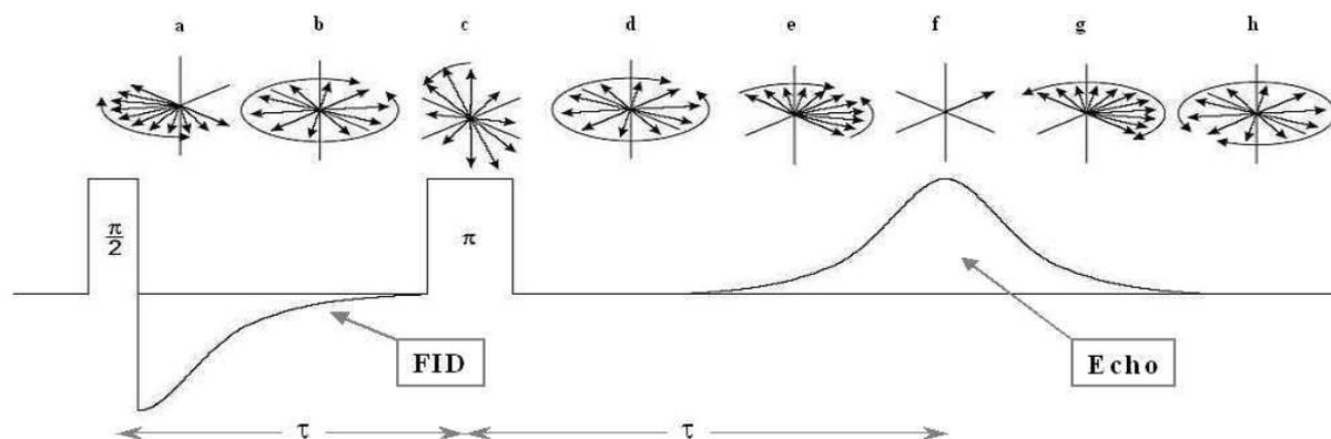
Figure 33 : Schéma d'une expérience d'écho de spin.
