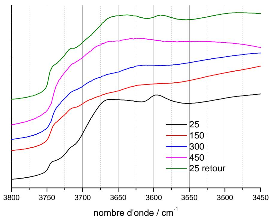
**Figure 11 : Evolution des spectres DRIFT observée en fonction de la température lors du chauffage de titanyl/K-ZSM-5 (Si/Al=27).**
