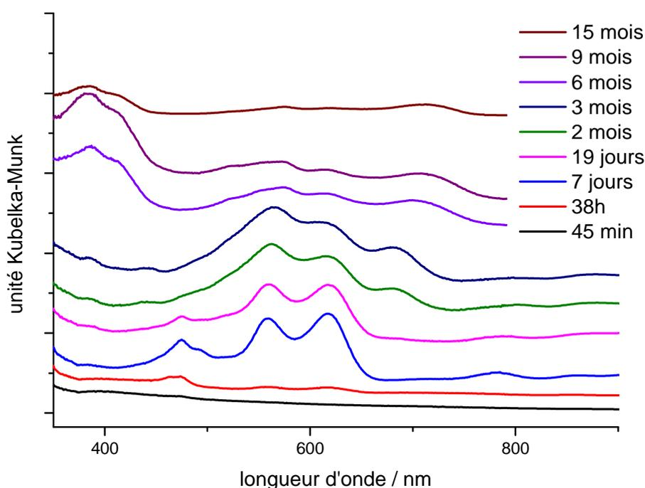
**Figure 8 :** Evolution des spectres UV-visible en réflexion diffuse du système *t*-St@TiO<sub>2(oxalate)</sub>/H-ZSM-5 (Si/Al=27) suivis pendant 15 mois après le mélange. Les spectres ont été décalés verticalement pour une meilleure lisibilité.
