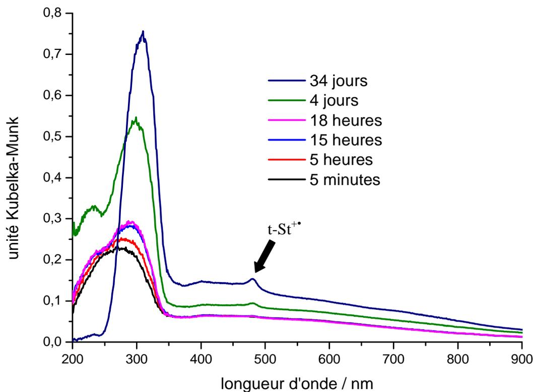
**Figure 4 :** Evolution des spectres UV-visible en réflexion diffuse enregistrés pendant 34 jours après le mélange du *t*-St avec  $\text{TiO}_2(\text{TiCl}_3)/\text{H-FER}$ .
