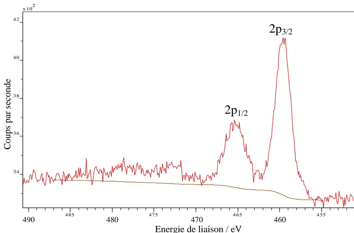
Figure 5 : Spectre XPS de  $\text{Ti } 2p$  pour  $\text{TiO}_2/\text{H-FER}$ .
