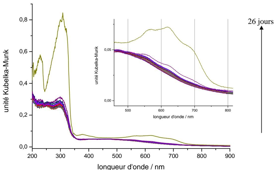
**Figure 13 :** Evolution des spectres UV-visible en réflexion diffuse enregistrés pendant 26 jours après le mélange du *t*-St avec TiO<sub>2</sub>(TiCl<sub>3</sub>)/H-MOR.
