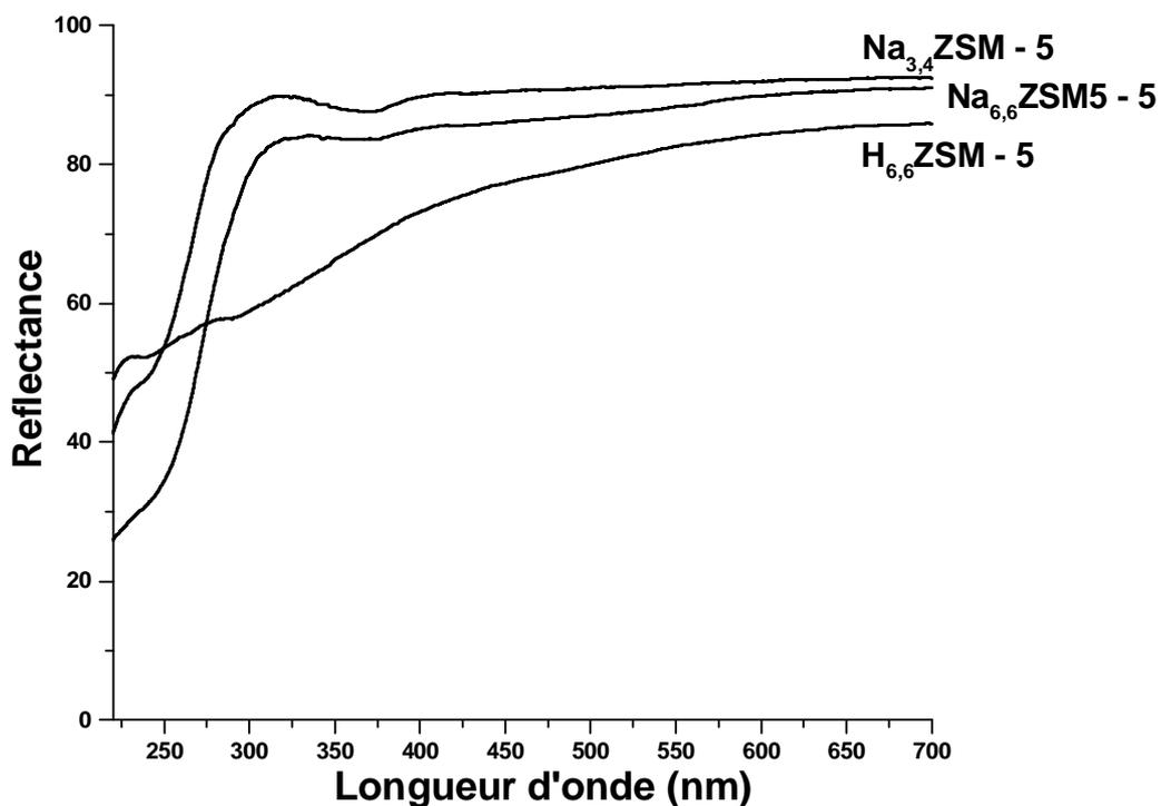
Figure 18: Spectres d'absorption UV-Visible par réflexion diffuse de zéolithes  $M_n(AlO_2)_n(SiO_2)_{96-n}$  ( $M=Na^+, H^+$ ;  $n=3,4; 6,6$ ) après calcination à 773K et placées dans des cellules de silice suprasil.
