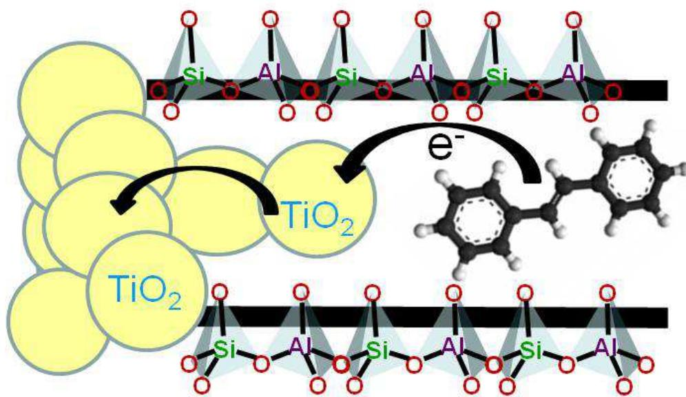
**Figure 1: Représentation schématique du système idéal comportant une molécule chromophore adsorbée dans les canaux d'une zéolithe et à proximité de nanoparticules de TiO<sub>2</sub> présentes dans le volume poreux.**
