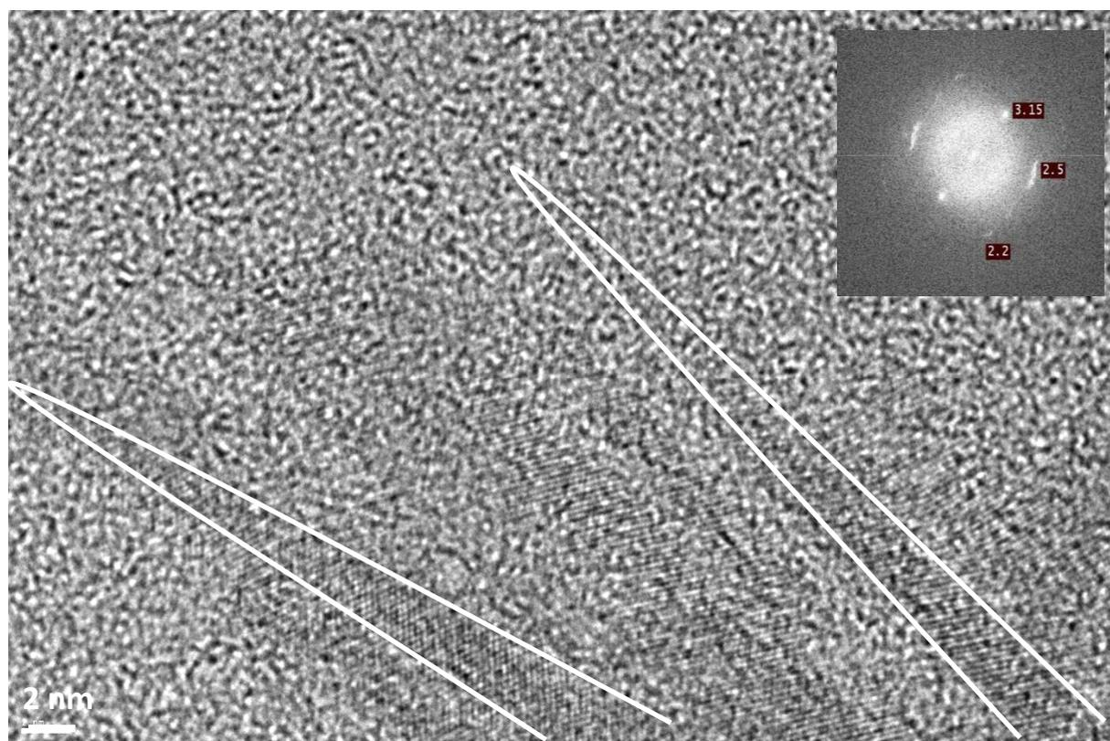
Figure 9 : Image haute résolution de la zone 1 de  $\text{TiO}_2$  sous forme rutile avec des baguettes dans  $\text{TiO}_2/\text{H-ZSM-5}$  ( $\text{Si/Al}=13,5$ ). Insert : transformée de Fourier de l'image.
