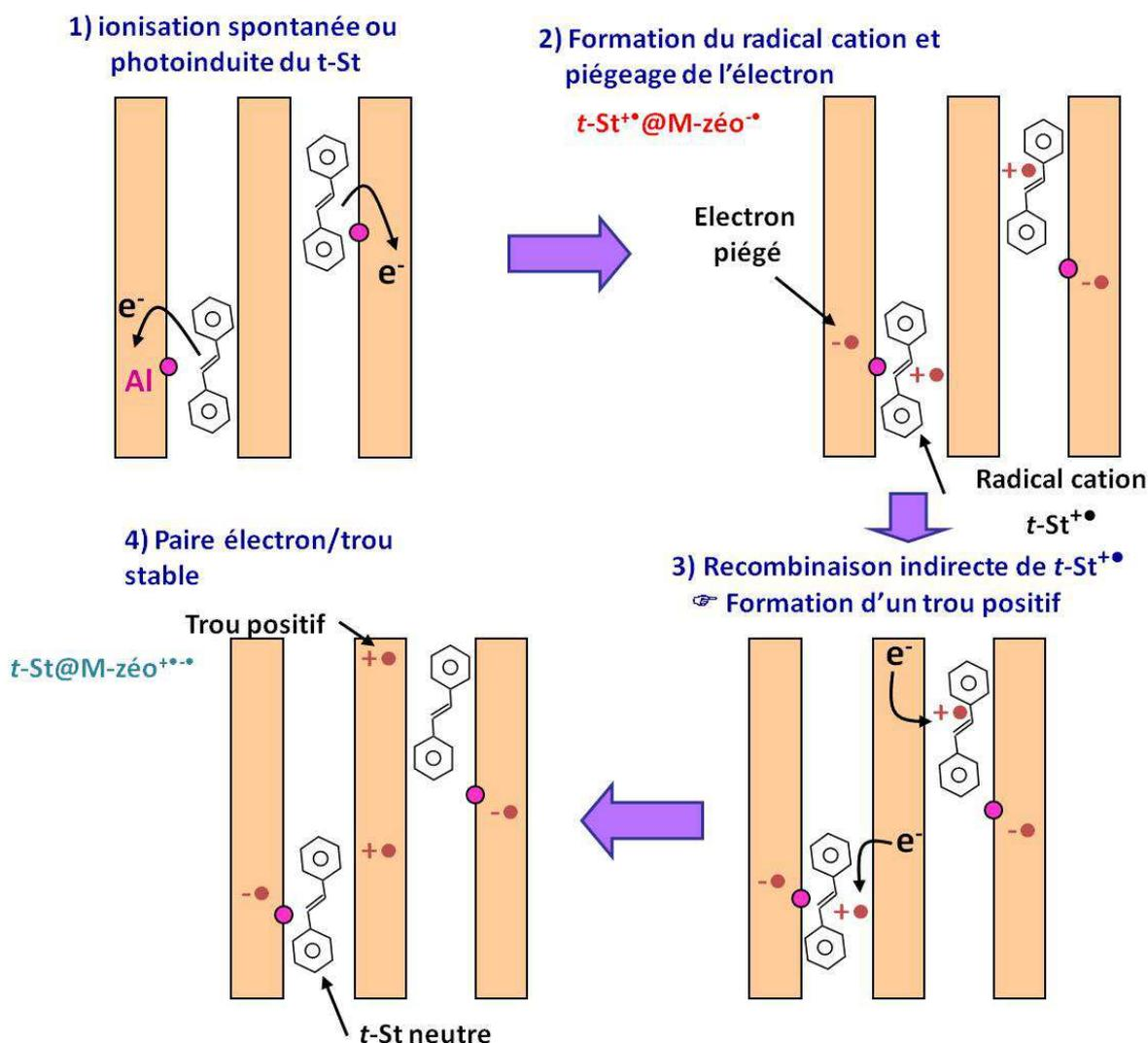
Figure 2 : Description du mécanisme de transfert d'électron.
