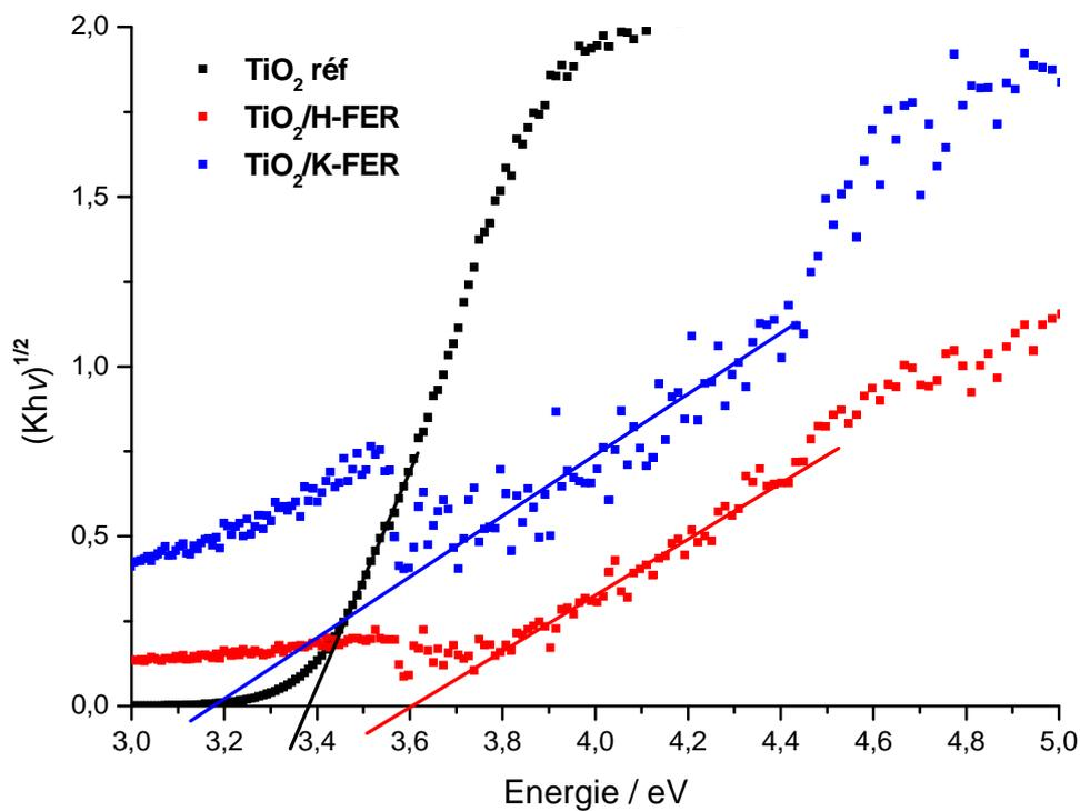
Figure 8 : Graphique de Tauc des bandes interdites indirectes pour  $\text{TiO}_2$  anatase (noir),  $\text{TiO}_2/\text{H-FER}$  (rouge),  $\text{TiO}_2/\text{K-FER}$  (bleu).
