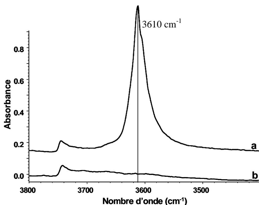
Figure 19 : Spectres d'absorption IR de  $\text{H}_{6,6}\text{ZSM-5}$  : (a) après déshydratation sous vide à  $773\text{ K}$ , (b) après adsorption et évacuation de la pyridine à  $400\text{ K}$ .
