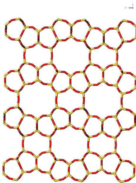
**Figure 8 : Représentation de la porosité du réseau de la ferrierite selon la direction [001].**
