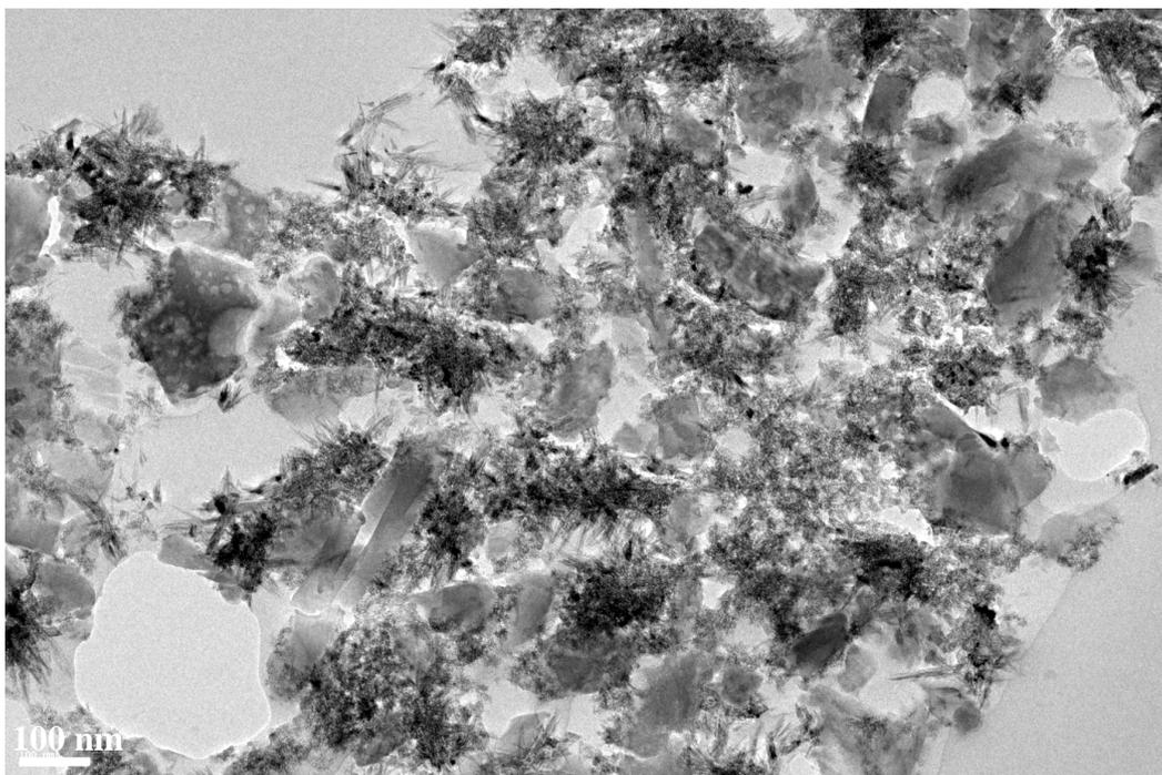
**Figure 7 : Image MET de TiO<sub>2</sub>/H-ZSM-5 (Si/Al=13,5).**
