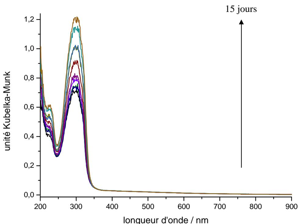
**Figure 29 :** Evolution des spectres UV-visible en réflexion diffuse enregistrés à différentes périodes de temps pendant 15 jours après le mélange du *t*-St avec ZnS<sub>(S<sub>2</sub>)</sub>/Na-FER.
