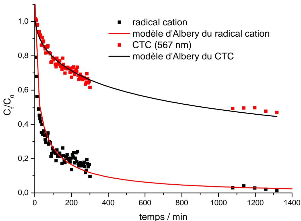
Figure 24 : Décroissance de la concentration spectrale en  $t\text{-St}^{*+}$  et CTC après photoexcitation à 300 nm de  $t\text{-St}@TiO_2(TiCl_3)/H\text{-MOR}$ .
