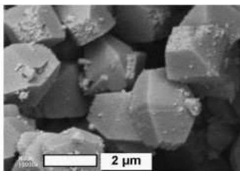
Figure 15 : Photographie de BEA brute obtenue par microscopie électronique à balayage. [12]
