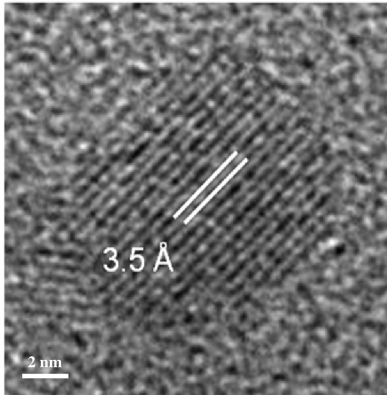
**Figure 17 :** image HRMET des particules sphériques observables sur l'échantillon de  $\text{TiO}_2/\text{H-ZSM-5}$  ( $\text{Si}/\text{Al}=27$ ).
