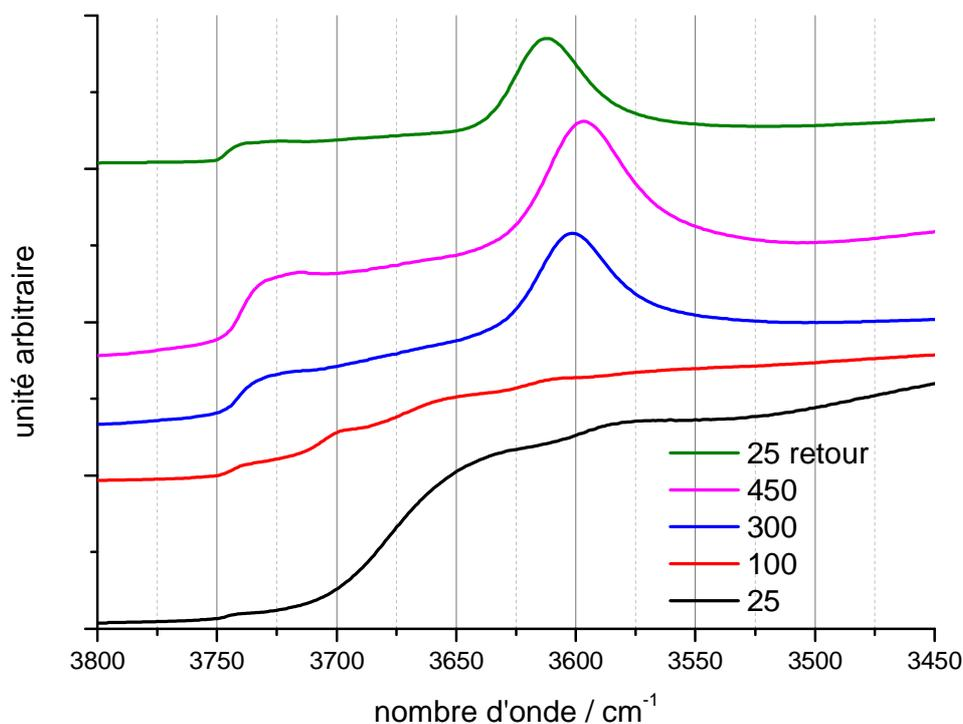
**Figure 2 :** Evolution des spectres DRIFT en fonction de la température lors du chauffage du composé de Ti/H-ZSM-5 (Si/Al=13,5).
