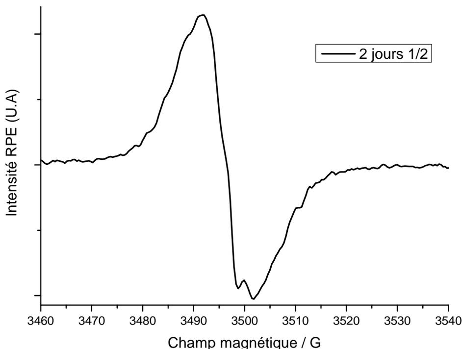
Figure 5 : Spectre RPE enregistré 2 jours  $\frac{1}{2}$  après l'adsorption du *t*-St dans  $\text{TiO}_2(\text{TiCl}_3)/\text{H-FER}$ .
