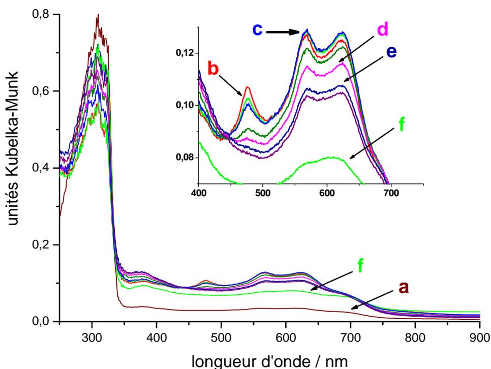
Figure 23 : Evolution des spectres UV-visible en réflexion diffuse enregistrés en fonction du temps après photoexcitation de *t*-St@ $\text{TiO}_2(\text{TiCl}_3)/\text{H-MOR}$  à 300 nm : a) avant irradiation ; b) 5 min après irradiation ; c) 15 min ; d) 10 heures ; e) 1 jour et f) 3 jours
