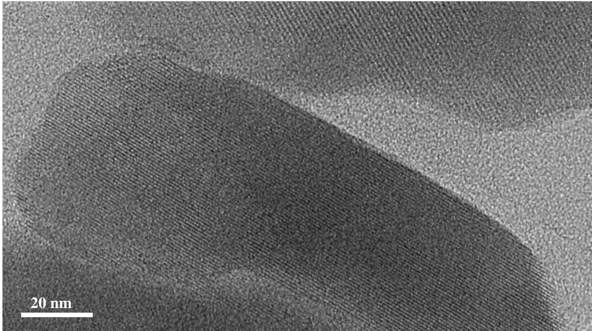
**Figure 24 : Observation du réseau de  $\text{TiO}_2/\text{H-MOR}$  par imagerie MET.**
