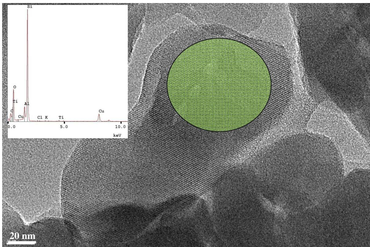
Figure 12 : Analyse EDX (insert) de la zone délimitée par un cercle sur l'image MET de TiO<sub>2</sub>/H-MOR.
