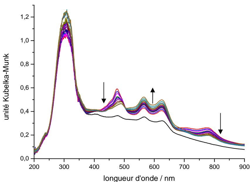
**Figure 20 :** Evolution des spectres UV-visible en réflexion diffuse de  $t\text{-St}@ \text{TiO}_2(\text{TiCl}_3)/\text{H-ZSM-5}$  (Si/Al=27) enregistrés à différentes périodes de temps pendant 6 jours après excitation à 300 nm.
