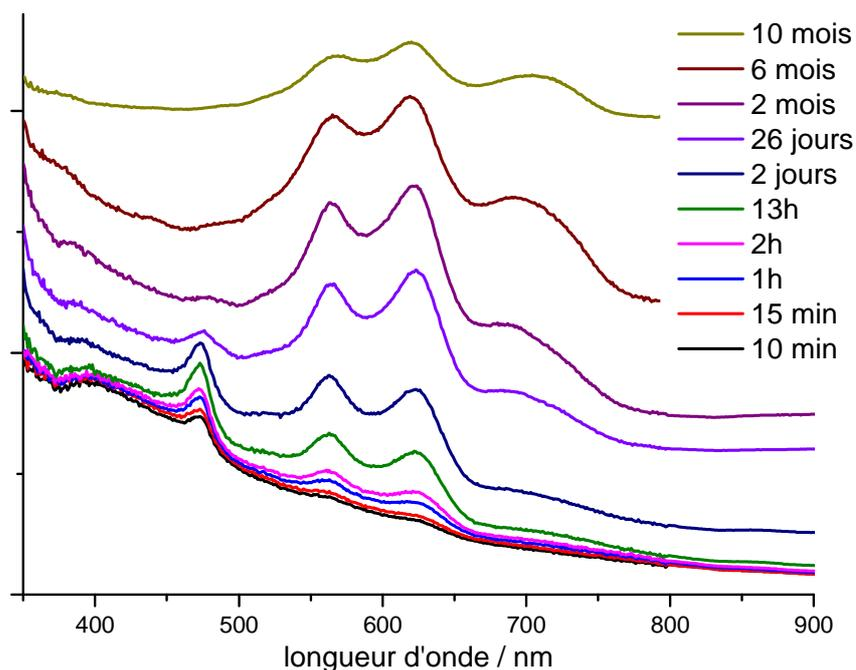
**Figure 7 :** Evolution des spectres UV-visible en réflexion diffuse enregistrés pendant 10 mois après le mélange du *t*-St et de  $\text{TiO}_2(\text{oxalate})/\text{H-ZSM-5}$  (Si/Al=13,5). Les spectres ont été décalés verticalement pour une meilleure lisibilité.
