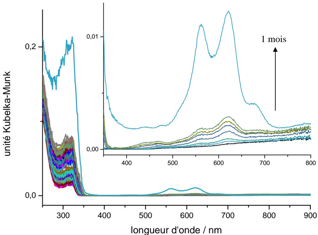
Figure 9 : Evolution des spectres UV-visible enregistrés à différentes périodes de temps pendant 1 mois après le mélange du *t*-St et de  $\text{TiO}_{2(\text{oxalate})}/\text{K-ZSM-5}$  (Si/Al=13,5).
