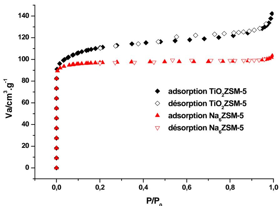
Figure 20 : Isothermes d'adsorption-désorption de l'azote des composés Na<sub>6,6</sub>-ZSM-5 et TiO<sub>2</sub>/H-ZSM-5 (Si/Al=13,5).
