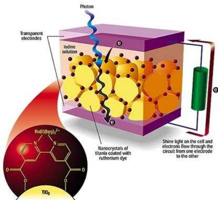
Figure 3: Schéma d'une cellule à pigments photosensibles. [9]
