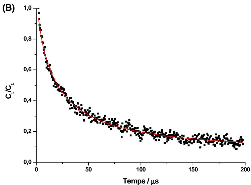
Figure 8 : (A) Spectres d'absorption UV-visible transitoires en réflexion diffuse reconstruits pour différents temps suivant l'excitation laser à 300 nm de *t*-St/H-BBEA 6 mois après le mélange. (B) Cinétique normalisée du déclin de *t*-St\*\* enregistrée à 475 nm suivant l'excitation laser à 300 nm réalisée 6 mois après le mélange. La courbe rouge représente le meilleur déclin simulé utilisant la fonction d'Albery ; les carrés représentent les points expérimentaux.
