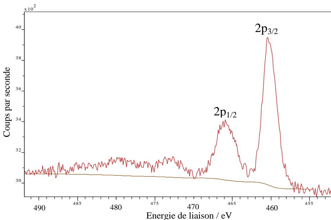
Figure 12 : Spectre XPS de Ti 2p pour TiO<sub>2</sub>/H-ZSM-5 (Si/Al= 13,5).
