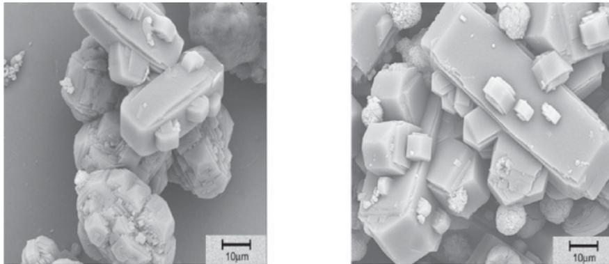
Figure 1: Photographie de cristaux de Na-ZSM-5 obtenue par microscopie électronique à balayage. [5]
