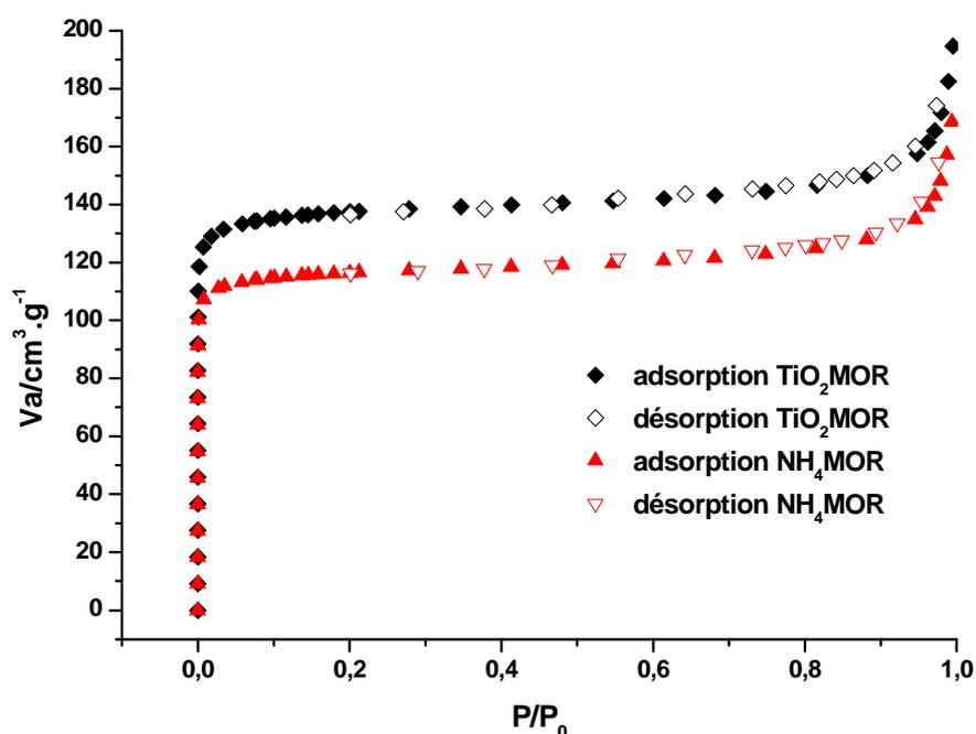
Figure 27 : Isothermes d'adsorption-désorption de l'azote des composés  $\text{NH}_4\text{-MOR}$  et  $\text{TiO}_2/\text{H-MOR}$ .
