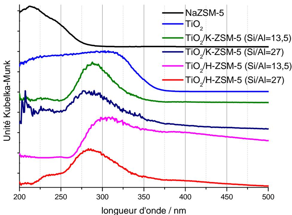
Figure 14 : Spectres d'absorption UV-visible de NaZSM-5, TiO<sub>2</sub>/K-ZSM-5, TiO<sub>2</sub>/H-ZSM-5 et TiO<sub>2</sub> anatase avec Si/Al=27 et 13,5.
