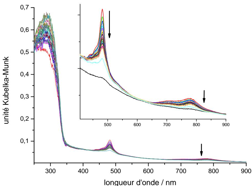
**Figure 16 : Evolution des spectres UV-visible en réflexion diffuse enregistrés à différentes périodes de temps pendant 2 jours de  $t\text{-St@TiO}_2(\text{oxalate})/\text{H-FER}$  après photoexcitation à 300 nm.**
