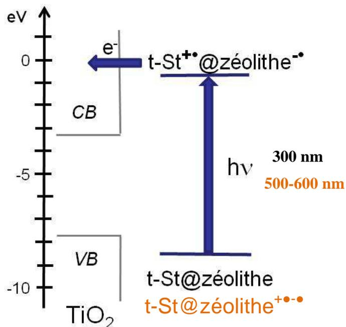
Figure 9: Diagramme d'énergie théorique de la bande de valence et de la bande de conduction de TiO<sub>2</sub> et représentation de l'orbitale «HOMO» et «LUMO» du *t*-St adsorbé dans une zéolithe
