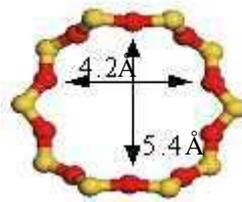
Figure 7 : Cycle à 10 tétraèdres de la ferrierite selon l'axe [001].
