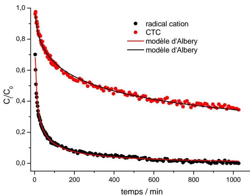
**Figure 19 : Décroissance de la concentration spectrale en radical cation et CTC après photoexcitation à 300 nm de *t*-St@ TiO<sub>2(oxalate)</sub>/K-ZSM-5 (Si/Al=13,5).**
