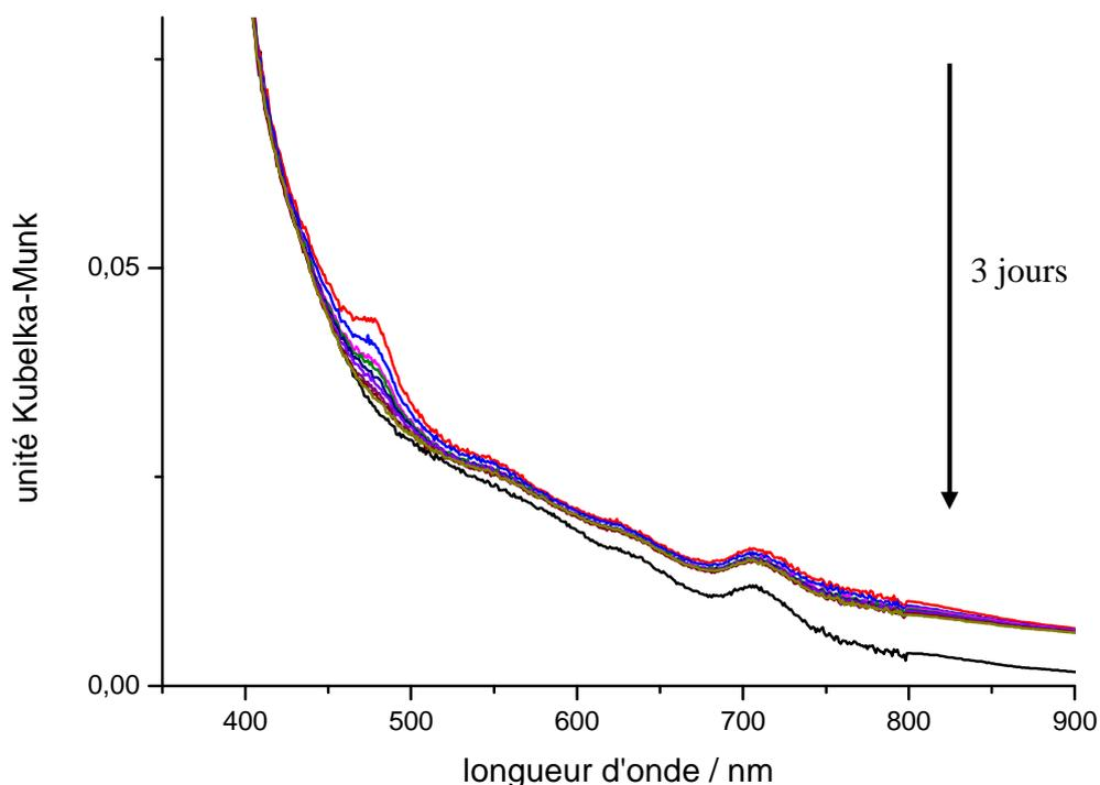
**Figure 33 : Evolution des spectres UV-visible en réflexion diffuse enregistrés à différentes périodes de temps pendant 3 jours de l'échantillon *t*-St@ $\text{ZnS}_{(S_2)}/\text{Na-MOR}$  après irradiation à 300 nm.**
