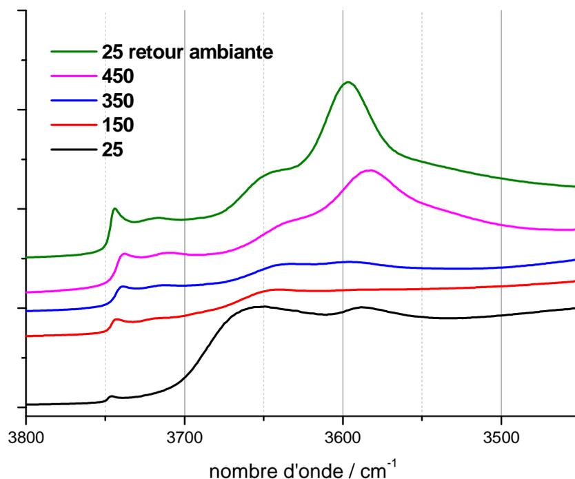
**Figure 2 : Evolution des spectres infrarouge en fonction de la température lors du chauffage du composé titanyl/ $\text{NH}_4$ -FER.**
