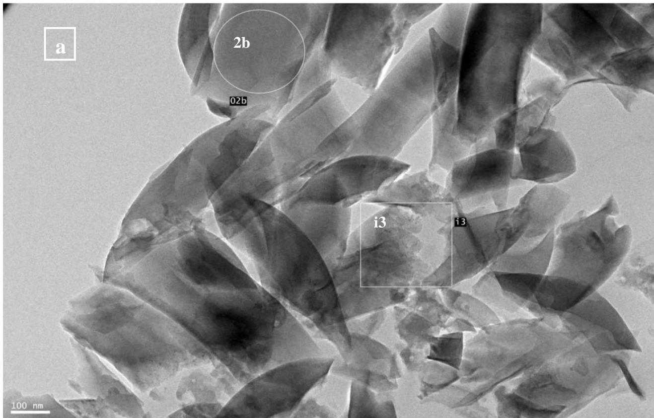
Figure 15a : microphotographie MET de TiO<sub>2</sub>/H-ZSM-5 (Si/Al=27).
