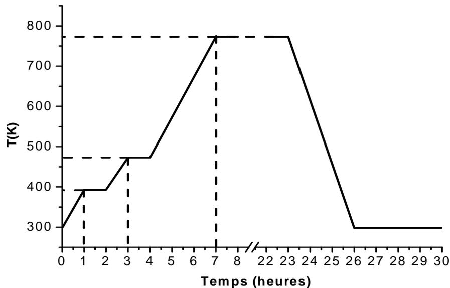
Figure 22 : Programme de montée en température du traitement thermique des zéolithes sous Ar.
