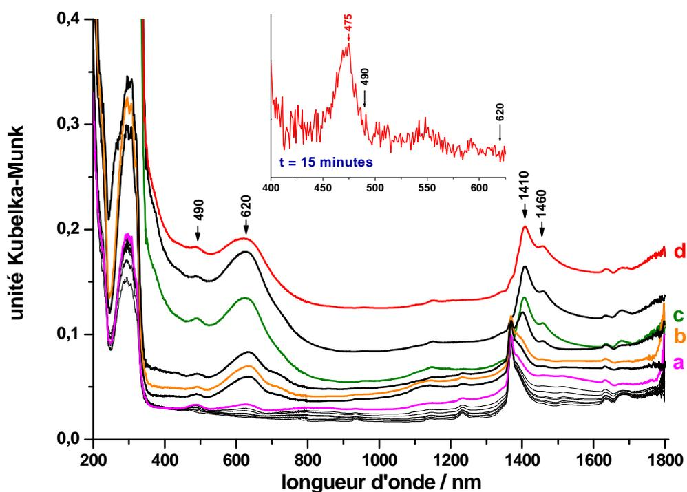
Figure 5 : Spectres d'absorption UV-visible en réflexion diffuse enregistrés en fonction du temps après la mise en contact de *t*-St avec H-GaBEA : (a) 2 jours, (b) 1 mois, (c) 1 an, (d) 1 an  $\frac{1}{2}$ . Insert : 15 min.
