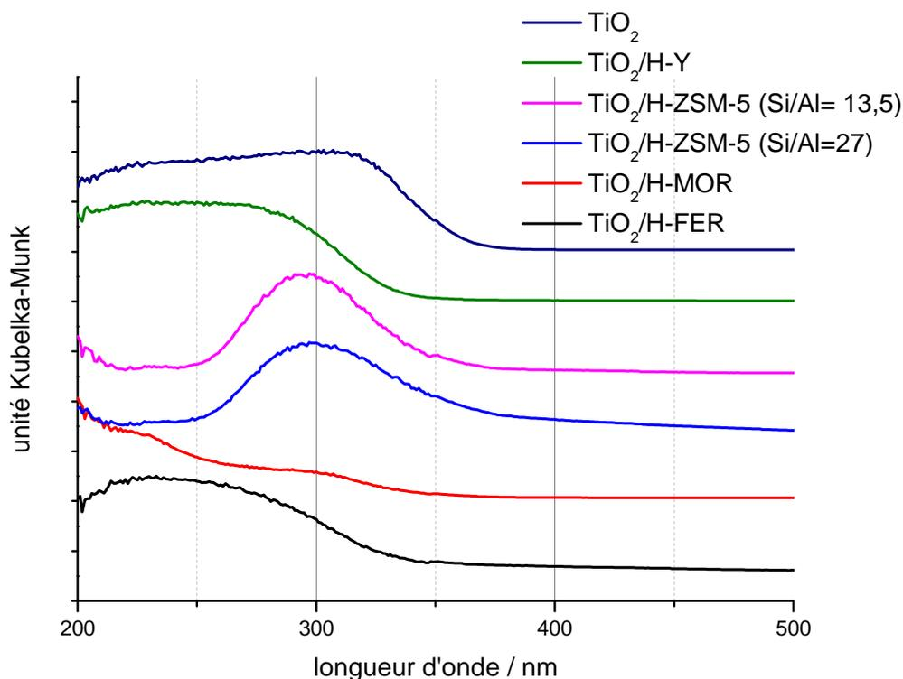
Figure 5 : Spectres d'absorption UV-visible en réflexion diffuse de  $\text{TiO}_2$  dans les différentes zéolithes après échange ionique et celui de la référence  $\text{TiO}_2$ .
