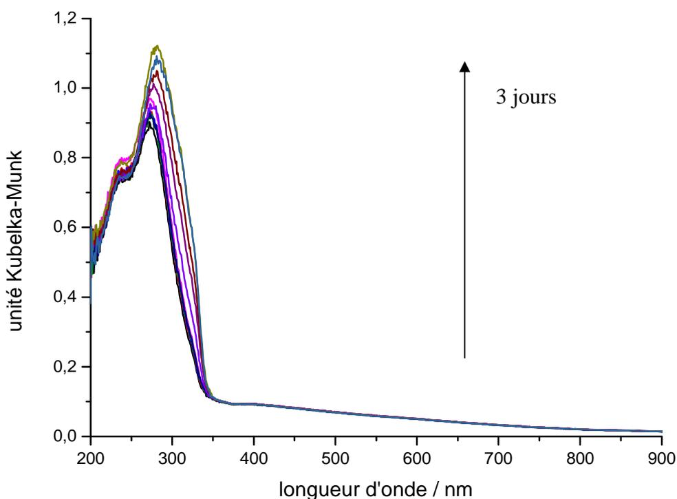
Figure 15 : Evolution des spectres UV-visible en réflexion diffuse enregistrés à différentes périodes de temps pendant 3 jours après le mélange du *t*-St avec  $\text{TiO}_{2(\text{oxalate})}/\text{H-FAU}$ .
