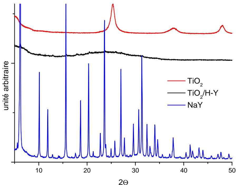
Figure 4 : Diffractogrammes RX de l'échantillon TiO<sub>2</sub>/H-Y, et de TiO<sub>2</sub> anatase et de NaY pris comme références.
