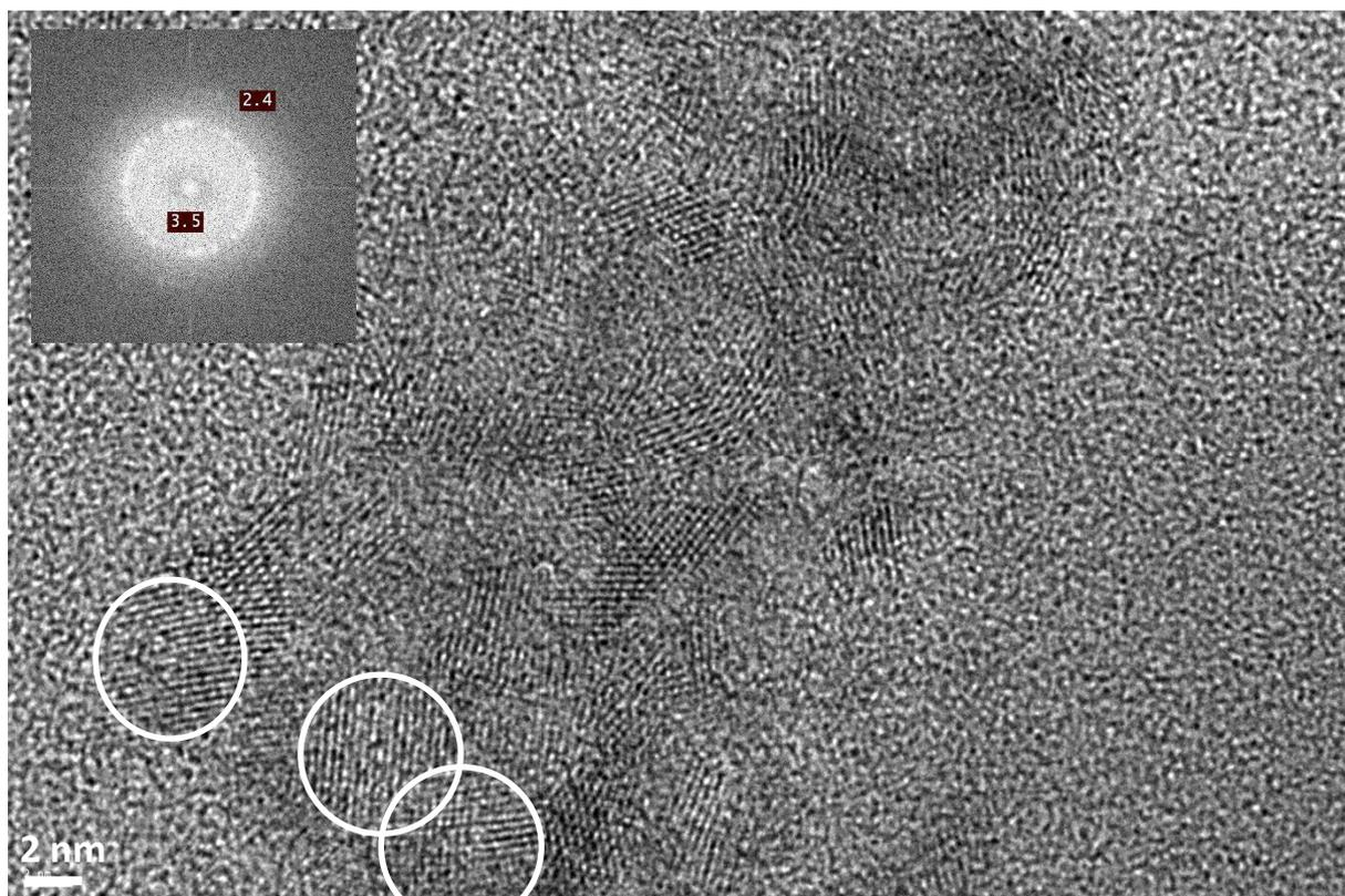
Figure 10 : Image haute résolution de la zone 2 de  $\text{TiO}_2$  sous forme anatase avec des particules sphériques (zones délimitées par un cercle) dans  $\text{TiO}_2/\text{H-ZSM-5}$  (Si/Al=13,5). Insert : transformée de Fourier de l'image.
