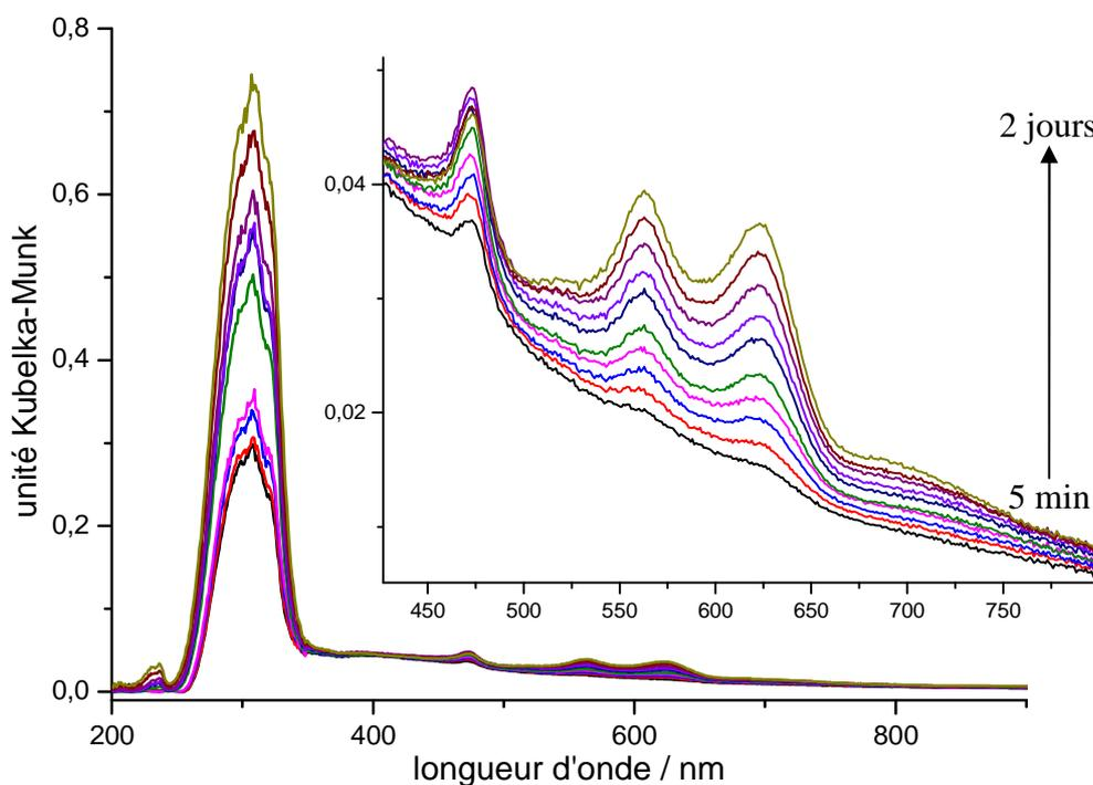
**Figure 6 :** Evolution des spectres UV-visible en réflexion diffuse enregistrés à différentes périodes de temps pendant 2 jours après le mélange du *t*-St et de  $\text{TiO}_2(\text{oxalate})/\text{H-ZSM-5}$  (Si/Al=13,5).
