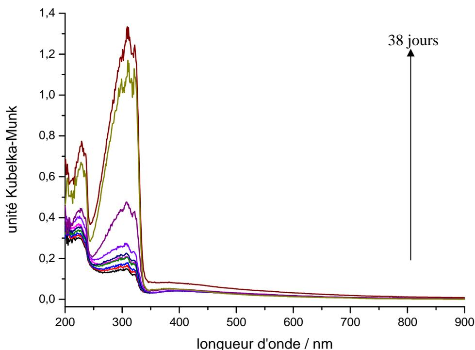
Figure 12 : Evolution des spectres UV-visible en réflexion diffuse enregistrés à différentes périodes de temps pendant 38 jours après le mélange du *t*-St avec  $\text{TiO}_{2(\text{oxalate})}/\text{H-MOR}$ .
