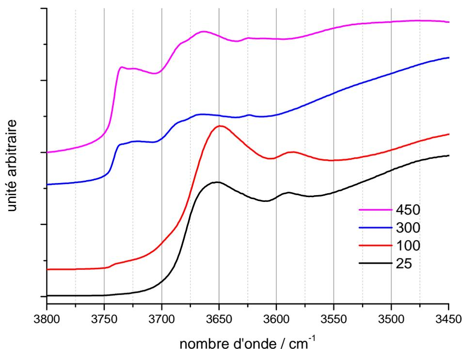
Figure 15 : Evolution des spectres DRIFT en fonction de la température lors du chauffage du composé ZnS/Na-MOR S1.
