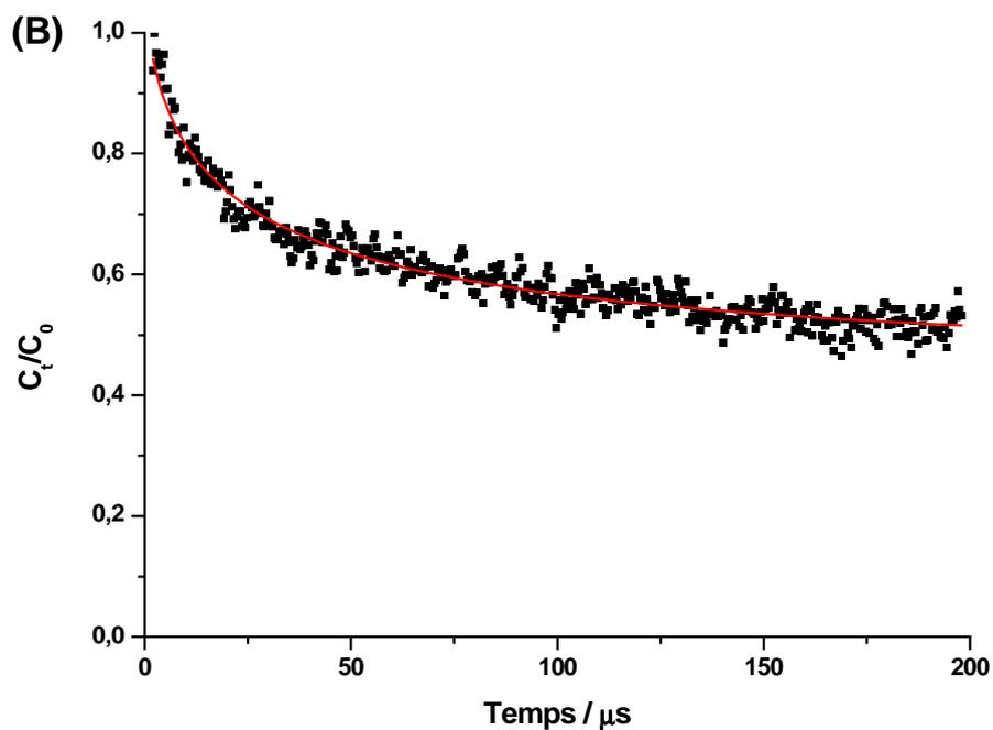
Figure 7B : Cinétique normalisée du déclin de *t*-St<sup>+</sup> enregistrée à 475 nm suivant l'excitation laser à 300 nm réalisée 6 mois après le mélange. La courbe rouge représente le meilleur déclin simulé utilisant la fonction d'Albery ; les carrés représentent les points expérimentaux.
