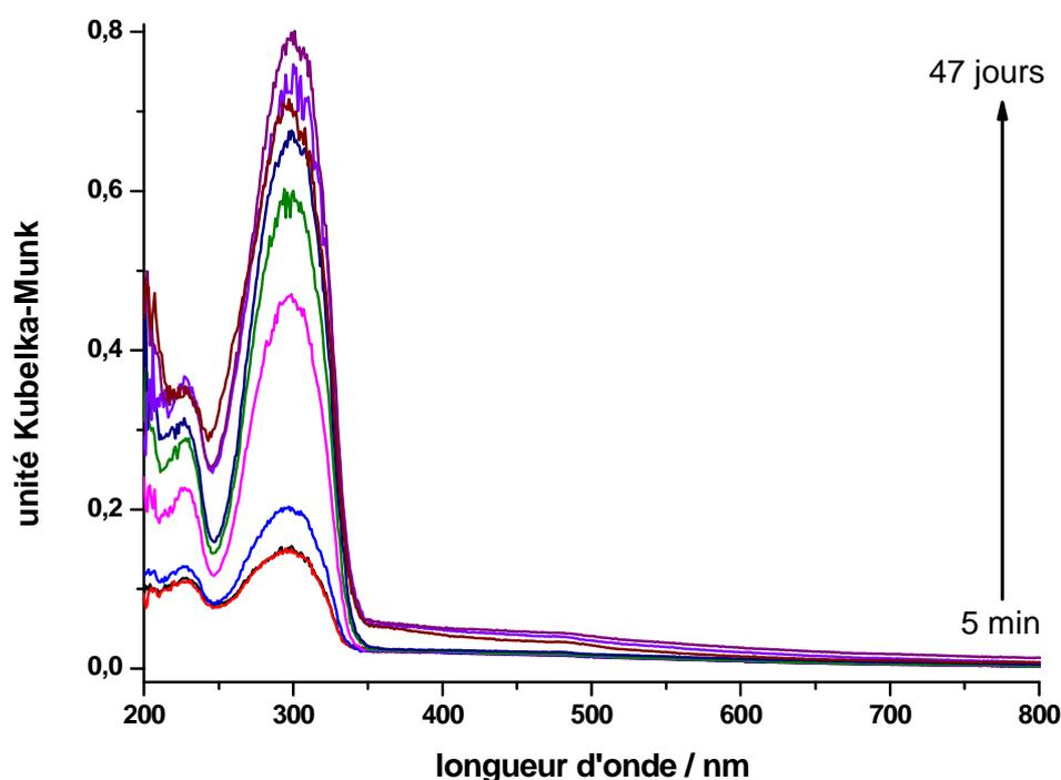
Figure 3 : Evolution des spectres UV-visible en réflexion diffuse enregistrés à différentes périodes de temps pendant 47 jours après le mélange du *t*-St avec  $\text{TiO}_2(\text{oxalate})/\text{H-FER}$ .
