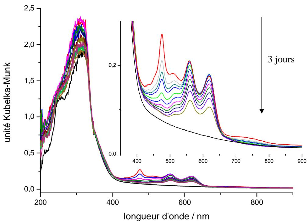
Figure 31 : Evolution des spectres UV-visible en réflexion diffuse enregistrés à différentes périodes de temps pendant 3 jours de l'échantillon  $t\text{-St@ZnS}_{(S_2)}/\text{Na-ZSM-5}$  (Si/Al=13,5) après irradiation à 300 nm.
