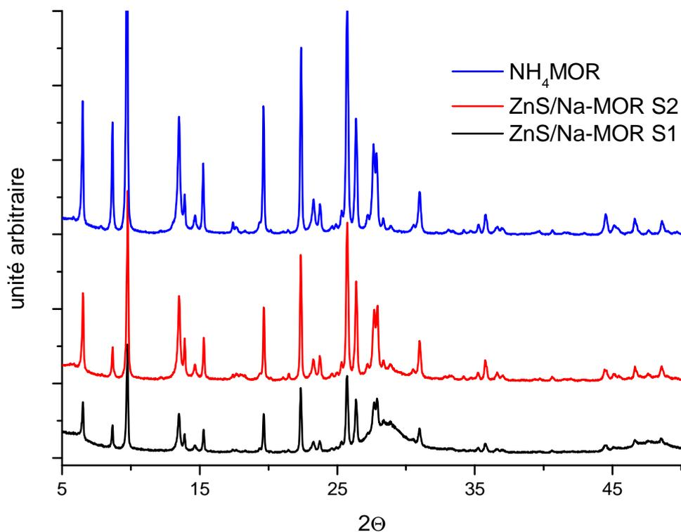
**Figure 18 :** Comparaison des diffractogrammes des échantillons ZnS/Na-MOR issus des synthèses 1 et 2 avec celui de la NH<sub>4</sub>-MOR.
