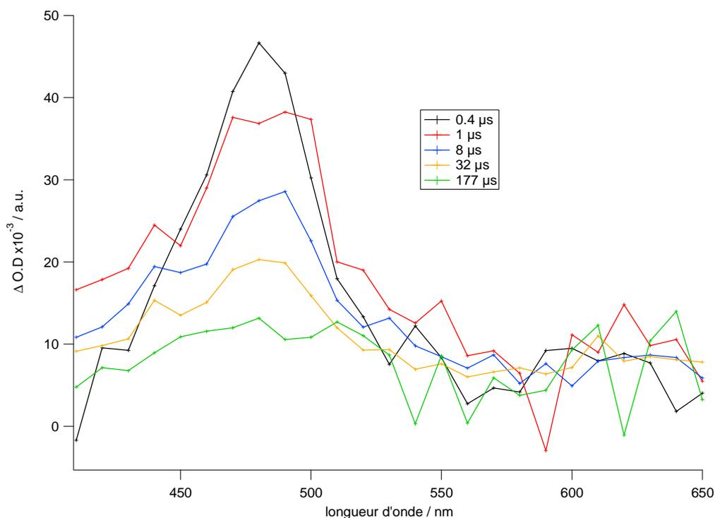
Figure 25 : Spectres d'absorption UV-visible transitoires reconstruits après irradiation à 300 nm du *t*-St adsorbé dans TiO<sub>2</sub>(oxalate)/K-FAU.
