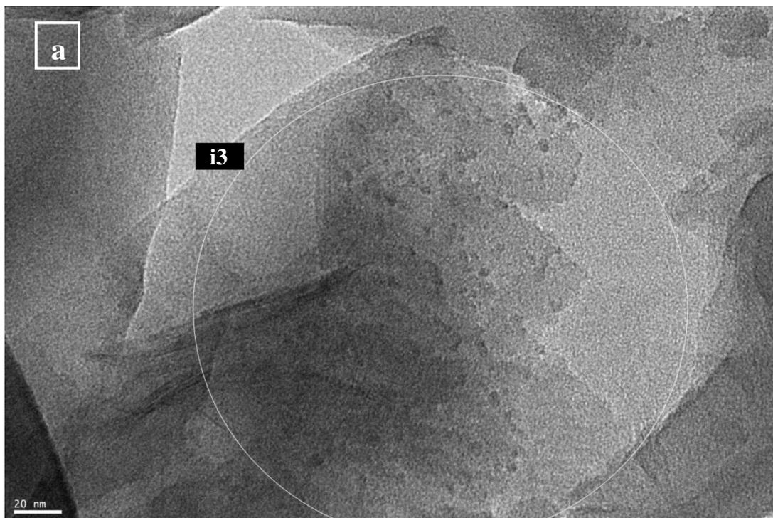
Figure 16a: microphotographie MET de la zone i3 de  $\text{TiO}_2/\text{H-ZSM-5}$  ( $\text{Si}/\text{Al}=27$ ).
