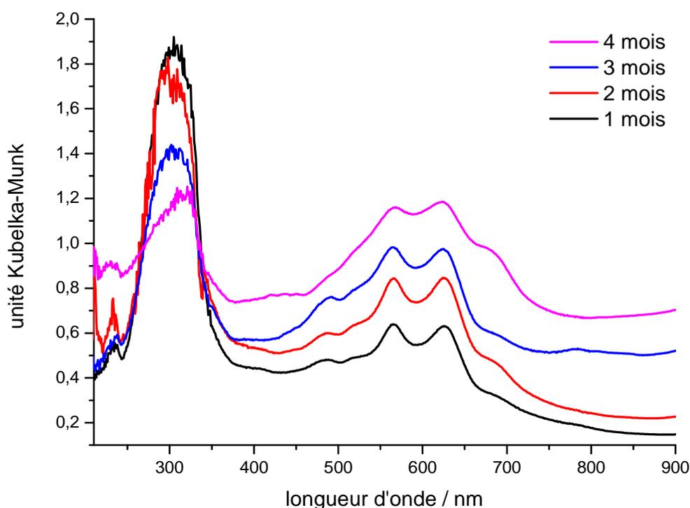
**Figure 21 :** Evolution des spectres UV-visible en réflexion diffuse de  $t\text{-St@TiO}_2(\text{TiCl}_3)/\text{H-ZSM-5}$  (Si/Al=27) enregistrés entre 1 mois et 4 mois après excitation à 300 nm. Les spectres ont été décalés verticalement pour une meilleure lisibilité.
