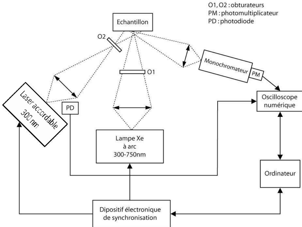
Figure 27: Montage expérimental de l'absorption UV-visible transitoire par réflexion diffuse.
