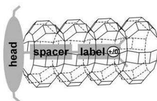
**Figure 4: Schéma d'une molécule de fermeture d'un canal de zéolithe. [29]**
