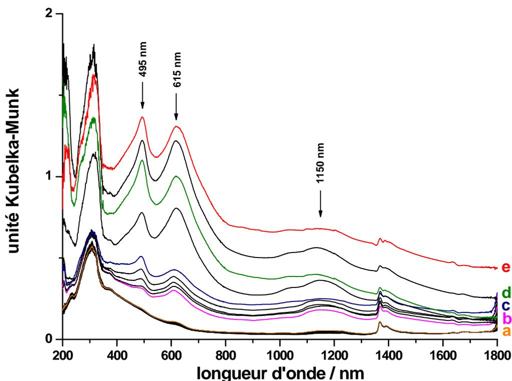
Figure 1 : Spectres d'absorption UV-visible en réflexion diffuse enregistrés en fonction du temps après la mise en contact de *t*-St avec H-AIBEA : (a) 1 jour, (b) 1 semaine, (c) 2 semaines, (d) 5 mois, (e) 10 mois.
