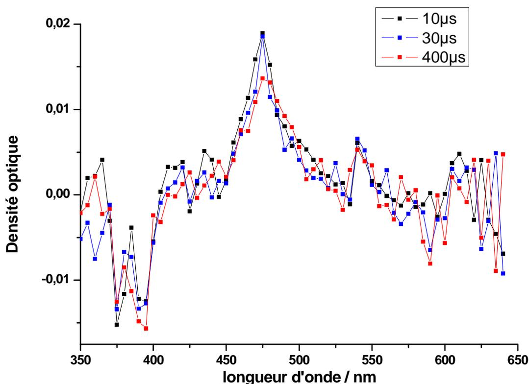
Figure 2 : Spectres d'absorption UV-visible transitoires en réflexion diffuse reconstruits pour différents temps (10, 30 et 400  $\mu$ s) après excitation laser (495 nm) de *t*-St@H-AIBEA 6 mois après le mélange.
