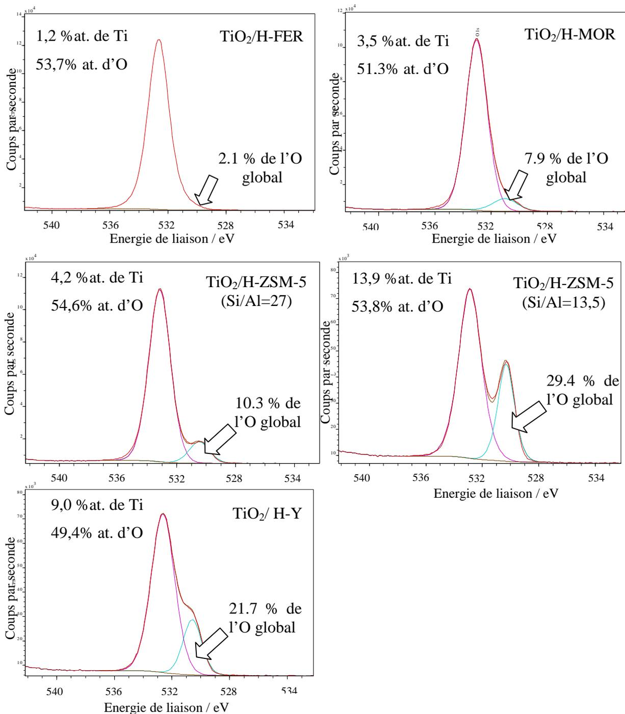
Figure 3 : Spectres XPS de l'O 1s des différentes zéolites après échange ionique avec Ti<sup>3+</sup> et formation de TiO<sub>2</sub>.
