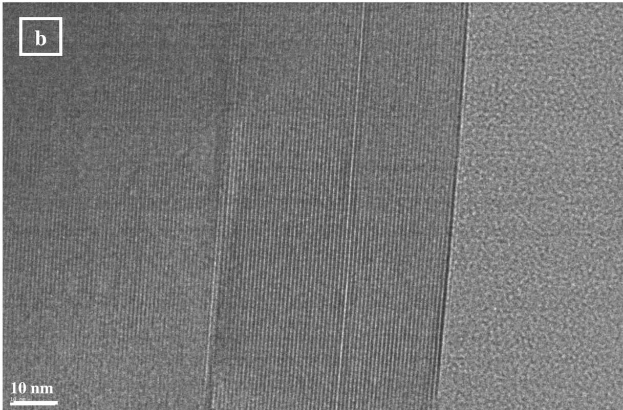
**Figures 6b : Images MET d'une vue des canaux de TiO<sub>2</sub>/H-FER.**
