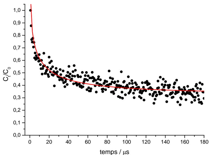
Figure 26 : Décroissance de la concentration spectrale en *t*-St<sup>•+</sup> après photoexcitation à 300 nm de *t*-St@TiO<sub>2</sub>(oxalate)/K-FAU en fonction du temps (noir = points expérimentaux ; rouge = modèle d'Albery).
