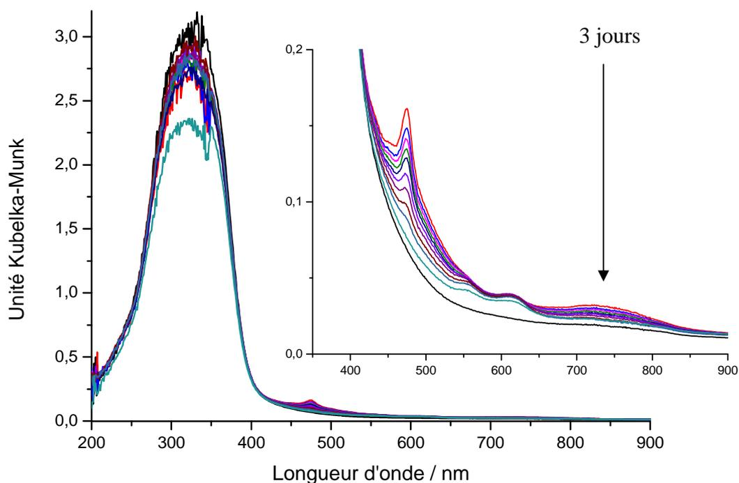
Figure 34 : Evolution des spectres UV-visible en réflexion diffuse enregistrés à différentes périodes de temps pendant 3 jours de l'échantillon  $t\text{-St}@ZnS_{(S1)}/\text{Na}$ -ZSM-5 (Si/Al=13,5) après irradiation à 300 nm.
