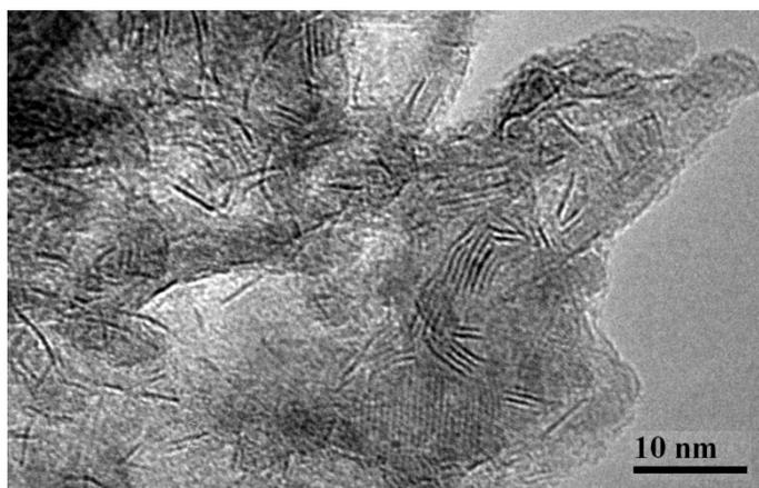
Figure 20. Cliché METHR de l'échantillon D43\_dp15eP sulfuré en phase liquide.
