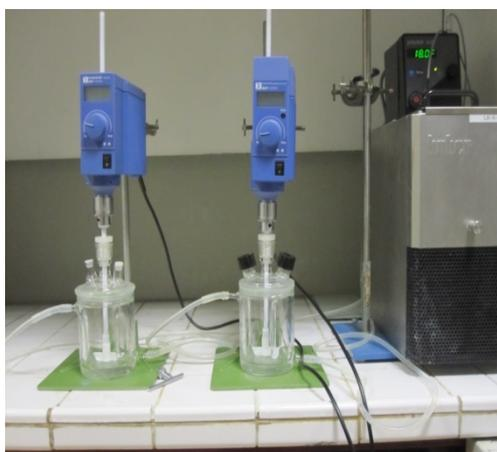
Figure 11. Vue schématique du montage utilisé pour la synthèse des alumines Sol-Gel.
